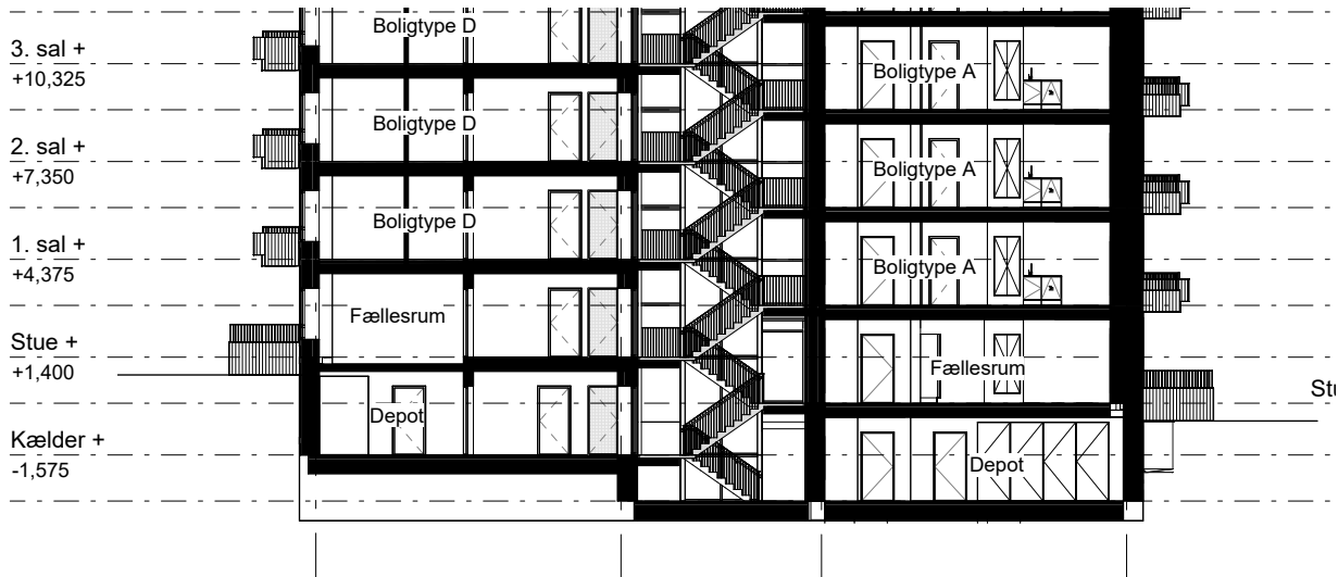
Principalsnit / 400-600 mm mellem terræn og gulvkote i stueplan
