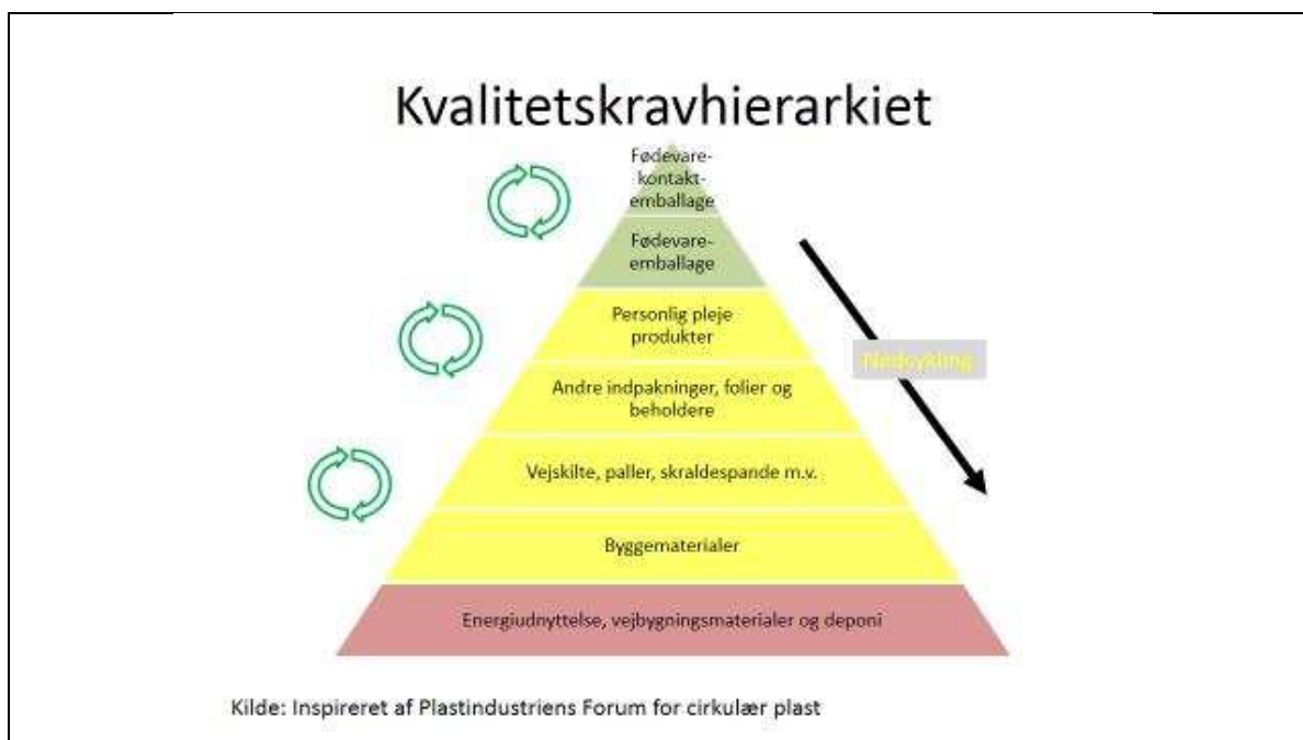
Figur 14: Kvalitetskravhierarkiet: Genbrug og genanvendelse kan lade sig gøre inden for hver kvalitetsgruppe, men ikke opad i hierarkiet. Nedad i hierarkiet benævnes nedcyklings.
