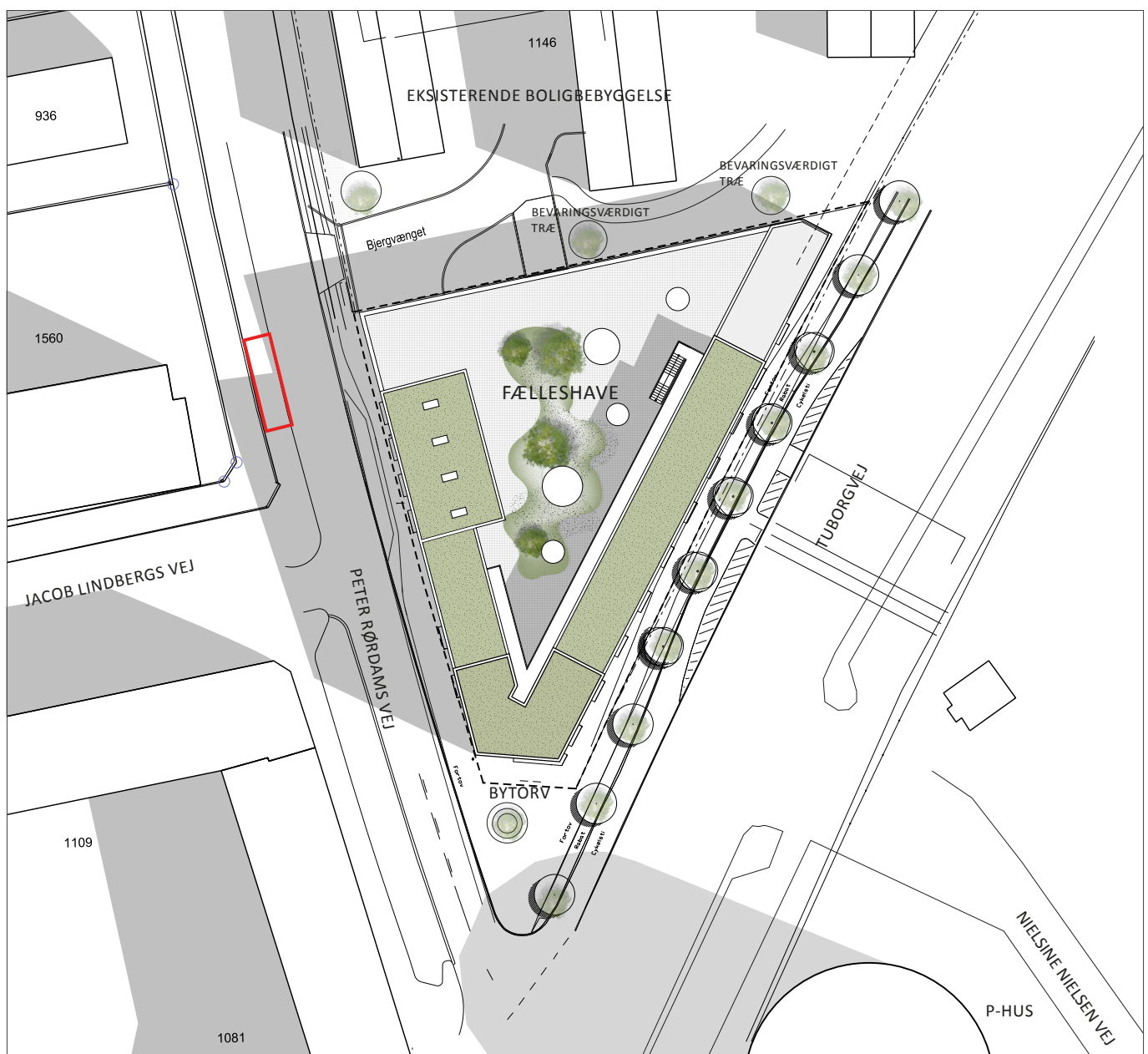
Situationsplan. Etablering af en lomme til renovationsbiler indebærer nedlæggelse af 2 parkeringspladser markeret med rød indramning. Ill. Vilhelm Lauritzen Arkitekter.
