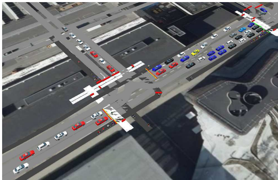
Figur 27 Eksempel på næsten opbrugt magasinkapacitet mellem Bernstorffsgade og til- og frakørslen til kælderen i eftermiddagsspidsstunden
