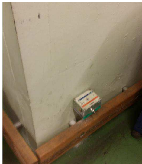
Figur 3. Placering af Geofon på undersiden af bærende søjle på Postterminalens stueetage.
