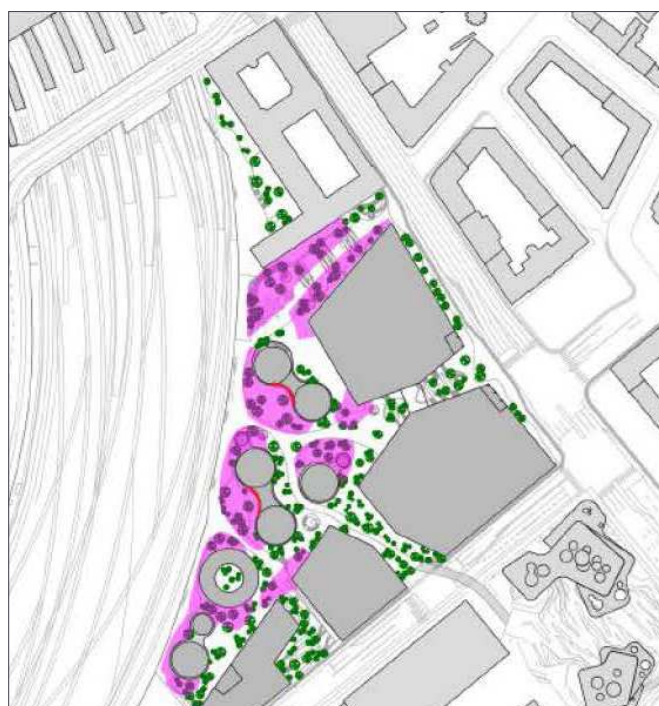
En vurdering af de områder, der har stor betydning for at opnå et behageligt eller acceptabelt vindmiljø (markeret med pink skravering). I disse områder skal der være ekstra fokus på lægivende eller vindbrydende beplantning. Illustration: Svend Ole Hansen Aps.
