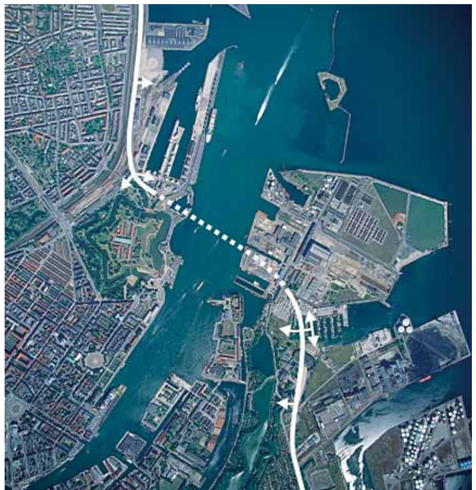
Linjeføring for kort sænkettunnel med tilslutningsanlæg
