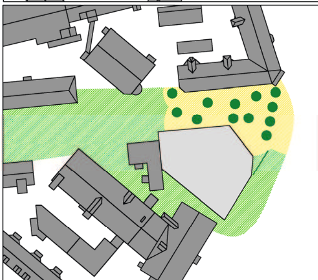
Figur 3. Illustration af vindmiljøet ved nyt kontorhus på Jagtvej 171 med anbefalet lægivning.
