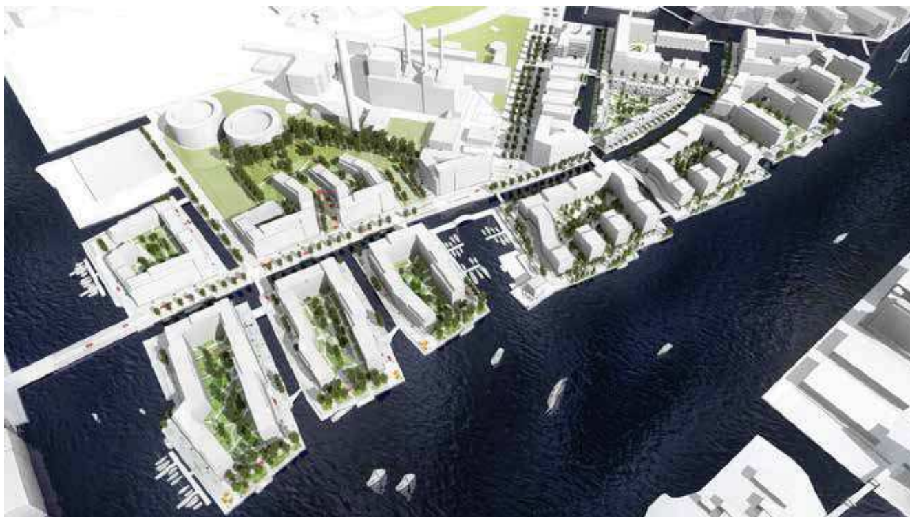
Illustrationen viser de tre grundejeres vision for en fuldt udbygget Enghave Brygge mellem Teglholmen og Havneholmen. Her ses bebyggelsesplanens hovedtræk: de 11 boligøer omgivet af vand, den 700 meter lange "Enghave Kanal" og lystbådehavnen "Enghaves Brygge" som bydelens centrale byrum. Herudover ses erhvervsbebyggelse placeret langs Tømmergravsgade og bypark mod H. C. Ørstedværkets arealer. Der er ikke vist, hvordan der kan bygges på virksomheden Radiatorlands bolig - se bebyggelsesplanen s. 7. Juul | Frost Arkitekter.
