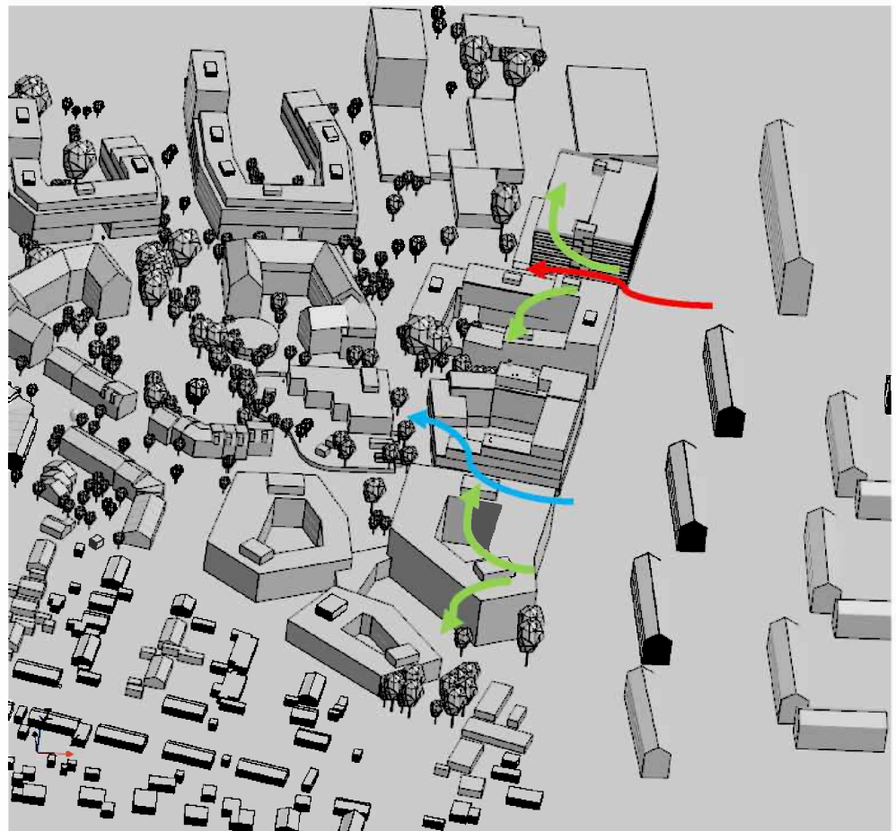
Figur 9-6 Område med potentiel vindforstærkning, illustration af vind over en bygning (blå pil), vind rundt om hjørnerne i gadeplan (rød pil) og vind langs facaderne (grøn pil). (Bilag 6 vindvurdering)
