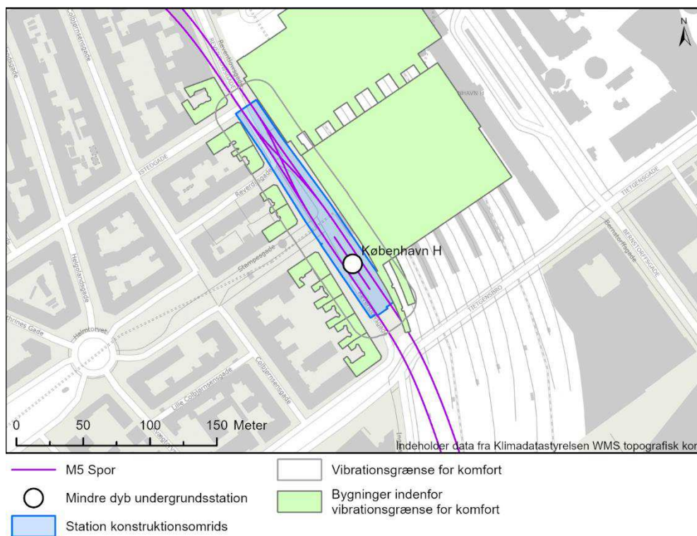
Figur 17-17 Vibrationskort for vibrationskomfort ved etablering af byggegrubeindfatning ved forgravning og nedvibrering af spuns ved København H (Kh).
