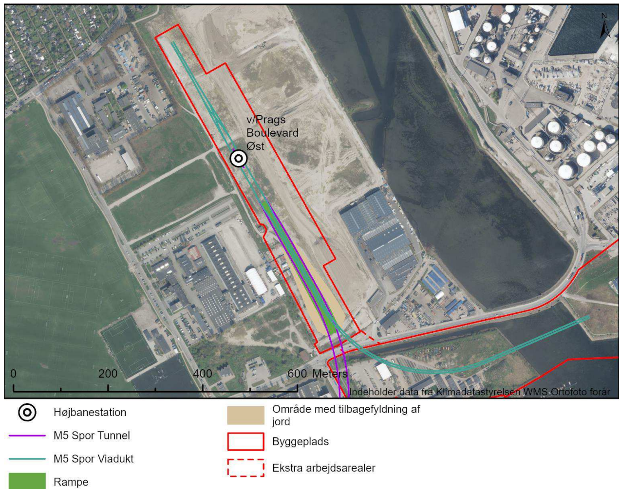
Figur 4-18 Ændret Byggepladsareal ved v/Prags Boulevard Øst. Det område, hvor der tilbagefyldes jord fra udgravningen af rampen, vil komme til at fremstå som en skråning, som vist i Figur 4-17.
