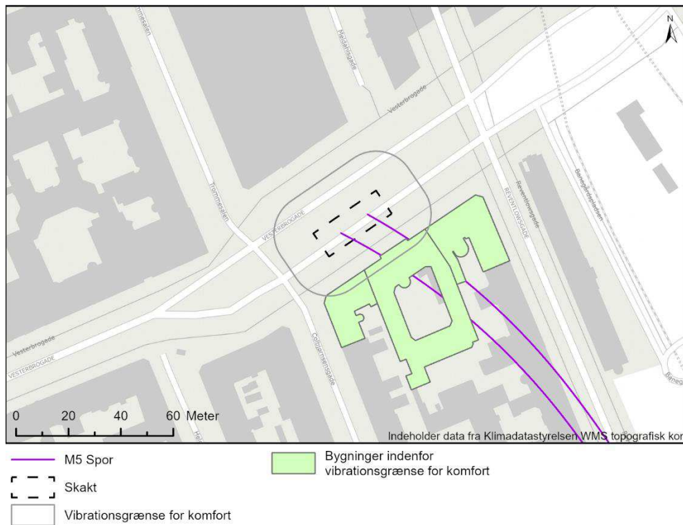
Figur 17-16 Vibrationskort for vibrationskomfort ved etablering af byggegrubeindfatning ved forgravning og nedvibrering af spuns ved Vesterbrogade Syd (Vbg).
