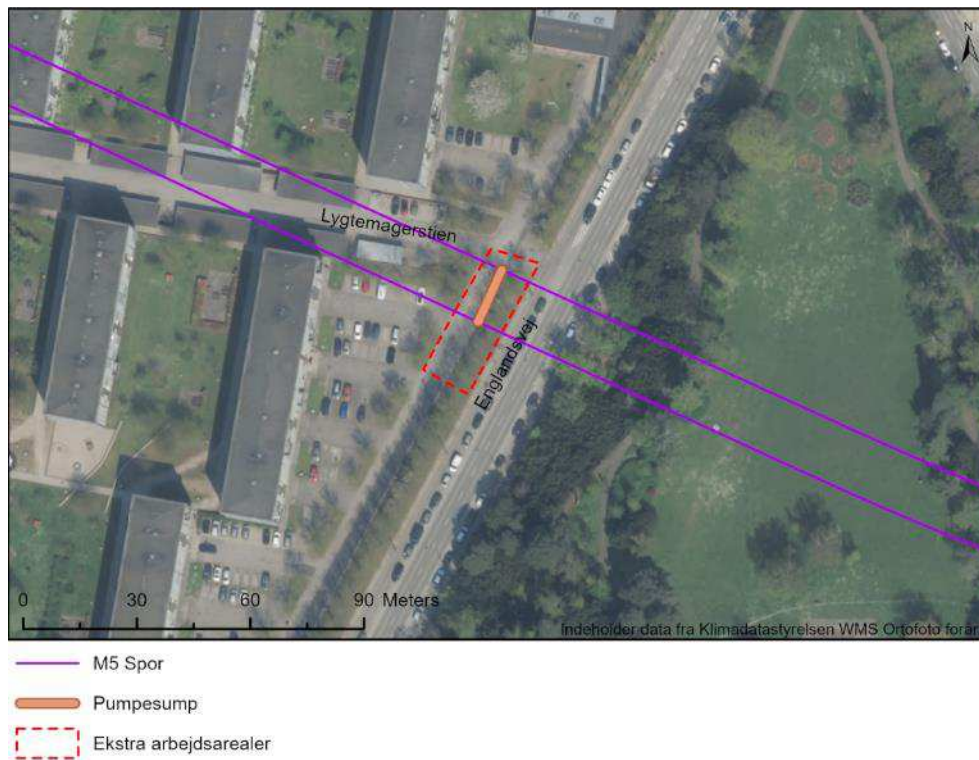
Figur 4-10 Placering af tværtunnel med pumpesump ved Lygtemagerstien.
