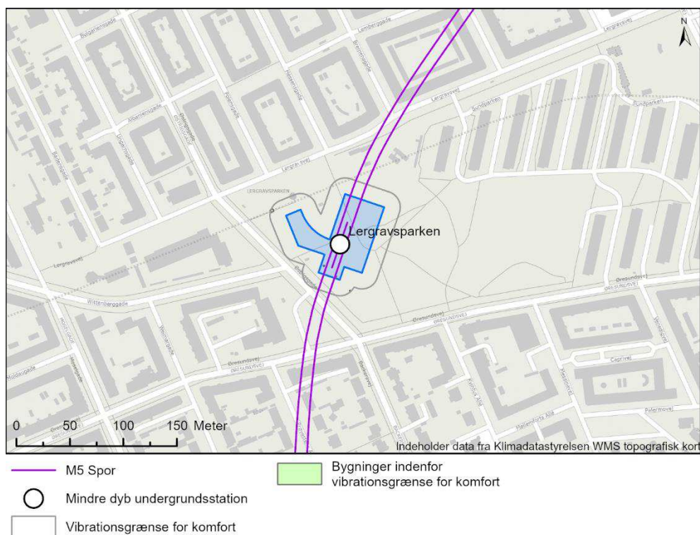
Figur 17-21 Vibrationskort for vibrationskomfort ved etablering af byggegrubeindfatning ved forgravning og nedvibrering af spuns ved Lergravsparken (Lgp).
