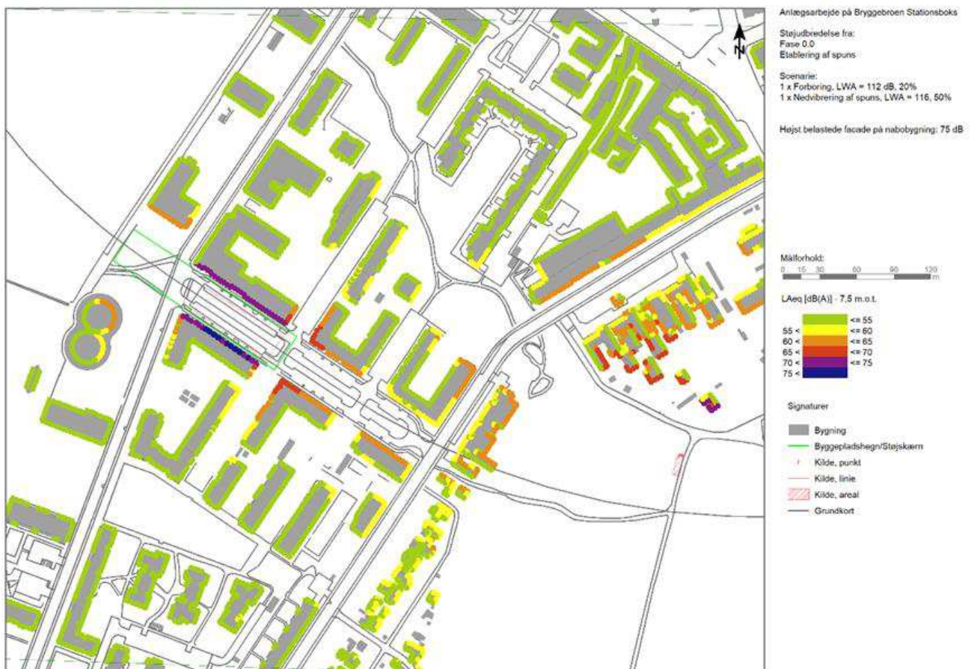
Figur 7-1 Støj kort for v/ Bryggebroen (Bgb) i fase 0.1 "Etablering af indfatningsvægge". Der er benyttet 4 sekantpæleboremaskiner og det højest beregnede støjniveau ved nærmeste facade er 75 dB.
