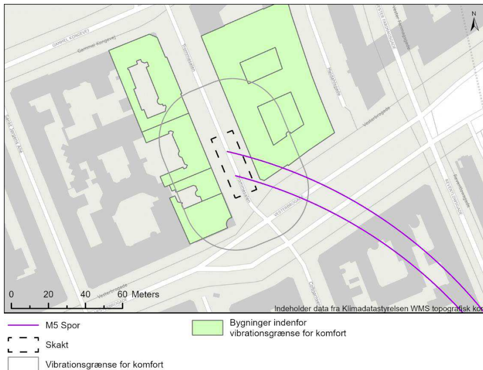
Figur 17-13 Vibrationskort for vibrationskomfort ved etablering af byggegrubeindfatning ved boring af sekantpæle ved Trommesalen (Tro).
