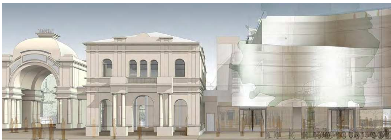
Facadeudsnit mod Vesterbrogade, hvor projektet møder Tivolis bevaringsværdige hovedindgang. Højderne og proportionerne er tilpasset den eksisterende bygningsmasse og forholder sig via tilbagetrækninger til den bevaringsværdige hovedindgang trods et radikalt anderledes arkitektonisk formsprog. Illustration Pei Cobb Freed & Partners.
