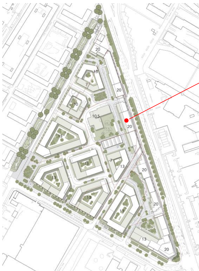
Figur 5 Plantegning med tagkoter af bygninger for simplificeret model til beregning af trafikstøj på terrasser.
