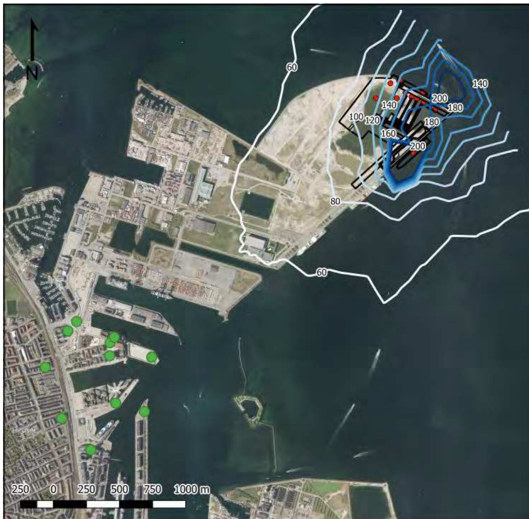
Figur 4.6: Scenarie 3. 19. højeste årlige timemiddelværdi for NO 2 i µg/m 3 . Receptorhøjde 72 meter.
