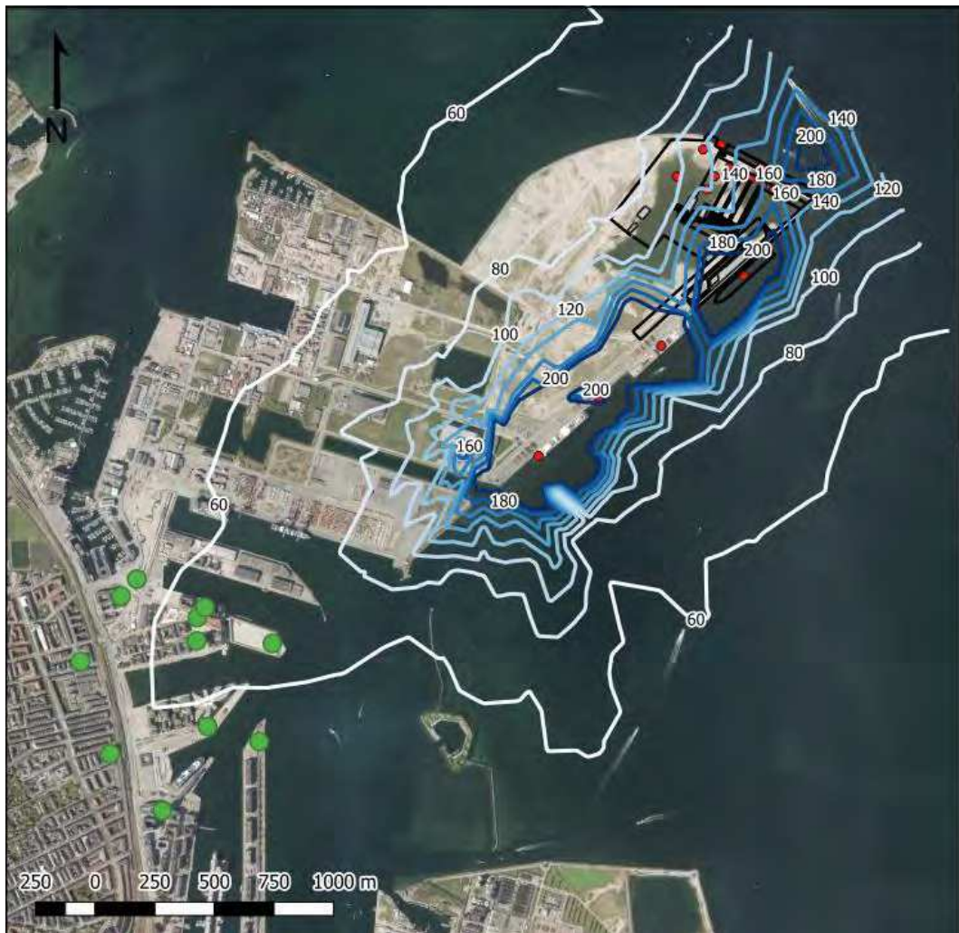
Figur 1.1: Scenarie 4. 19. højeste årlige timemiddelværdi for NO 2 i µg/m 3 . Receptorhøjde 72 meter.
