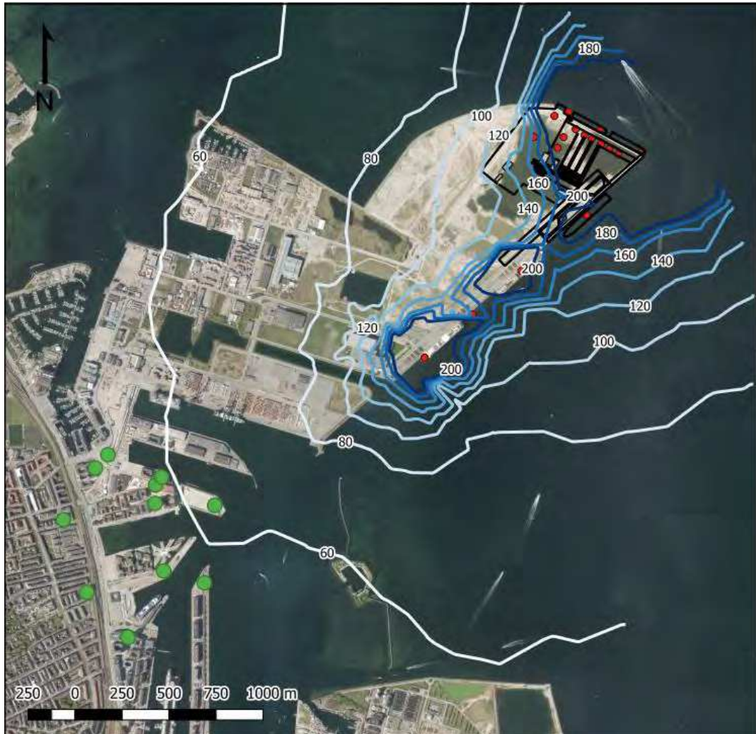
Figur 4.8: Scenarie 4. 19. højeste årlige timemiddelværdi for NO 2 i µg/m 3 . Receptorhøjde 38 meter.
