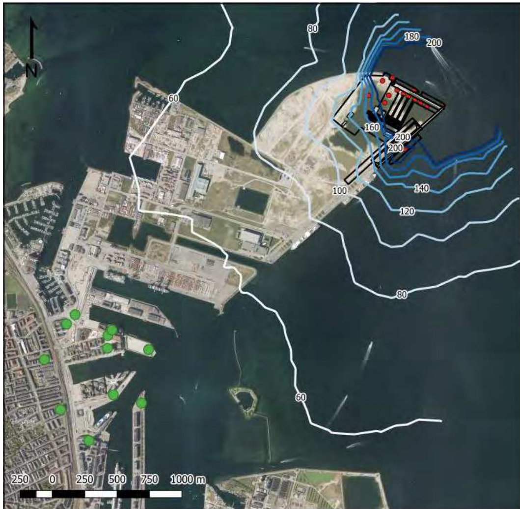
Figur 4.5: Scenarie 3. 19. højeste årlige timemiddelværdi for NO 2 i µg/m 3 . Receptorhøjde 38 meter.
