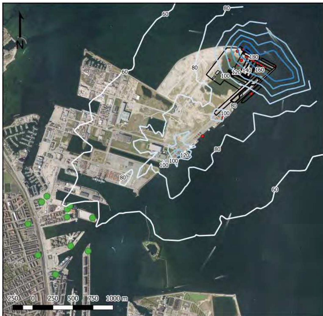
Figur 4.7: Scenarie 4. 19. højeste årlige timemiddelværdi for NO 2 i µg/m 3 . Receptorhøjde 1,5 meter.
