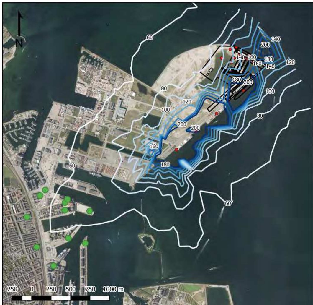
Figur 4.9: Scenarie 4. 19. højeste årlige timemiddelværdi for NO 2 i µg/m 3 . Receptorhøjde 72 meter.
