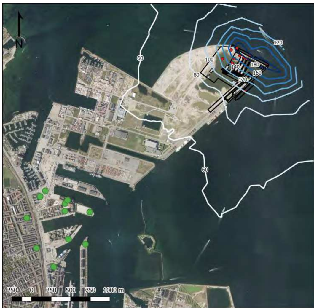
Figur 4.4: Scenarie 3. 19. højeste årlige timemiddelværdi for NO 2 i µg/m 3 . Receptorhøjde 1,5 meter
