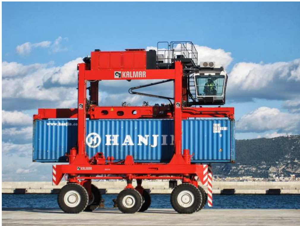
Figur 2.6: Eksempel på Shuttle Carrier, der anvendes til flytning af containere på land.
