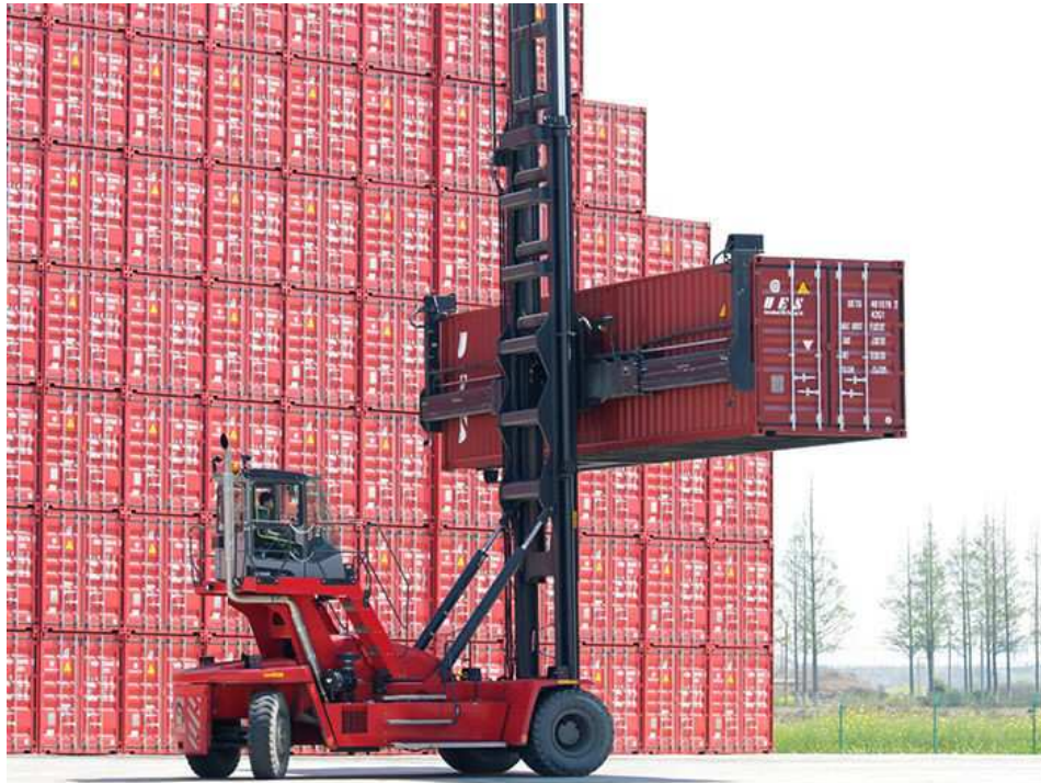
Figur 2.7: Eksempel på Empty Stack, der anvendes til flytning og stakning af tomme containere.
