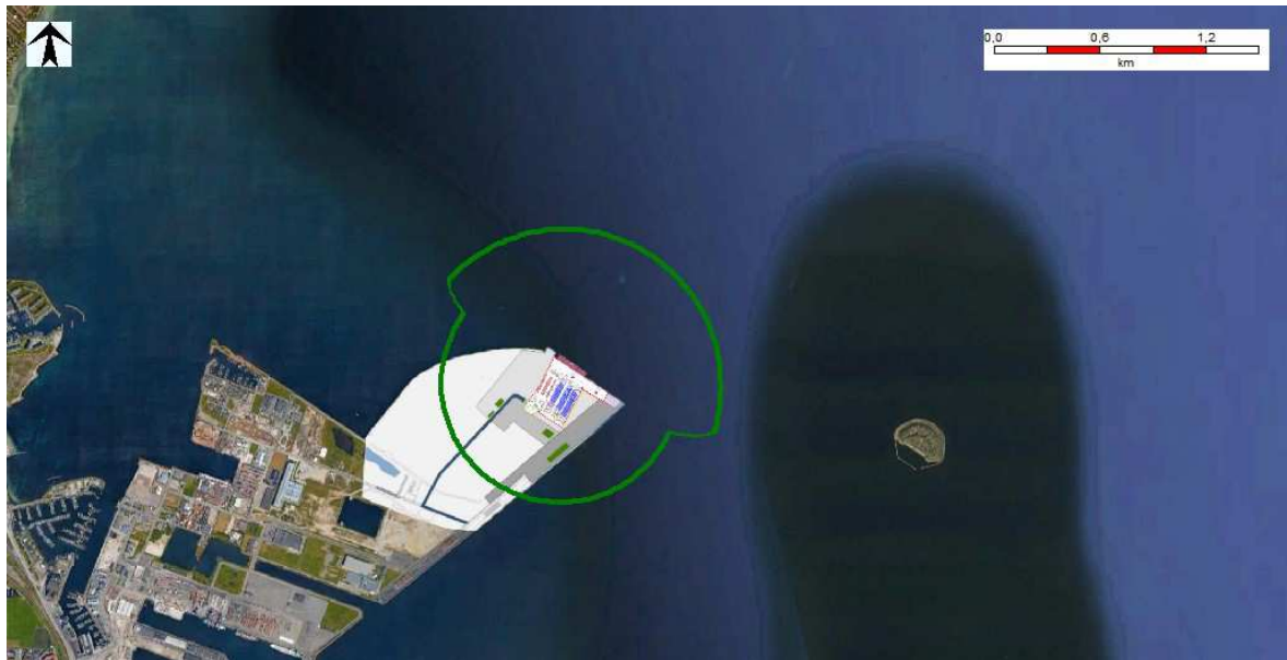
Figur 8.1 Beregnet maksimal konsekvensafstand (afgrænset af AEGL3-værdi 22 ved udslip af ammoniak og 50 mBar overtryk ved udslip af brandfarlig gas og efterfølgende eksplosion af gassky). Rambøll, marts 2019.
