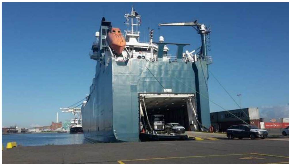
Figur 2.4: Eksempel på ro-ro anløbsplads, hvor sættevogne og stykgods kan køres direkte til/fra borde.
