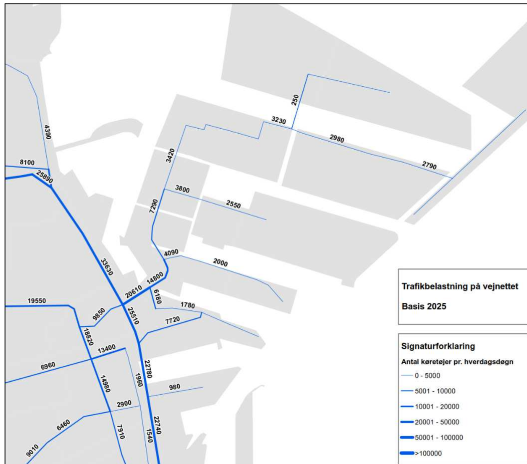
Figur 7.11: Trafikmængder på vejnettet i og omkring Nordhavn i basis 2025 modelberegningen. Kilde "Trafik-analyse Nordhavn 2018". Figuren skitserer forløbet af de veje, der indgår i modellen med trafiktal.
