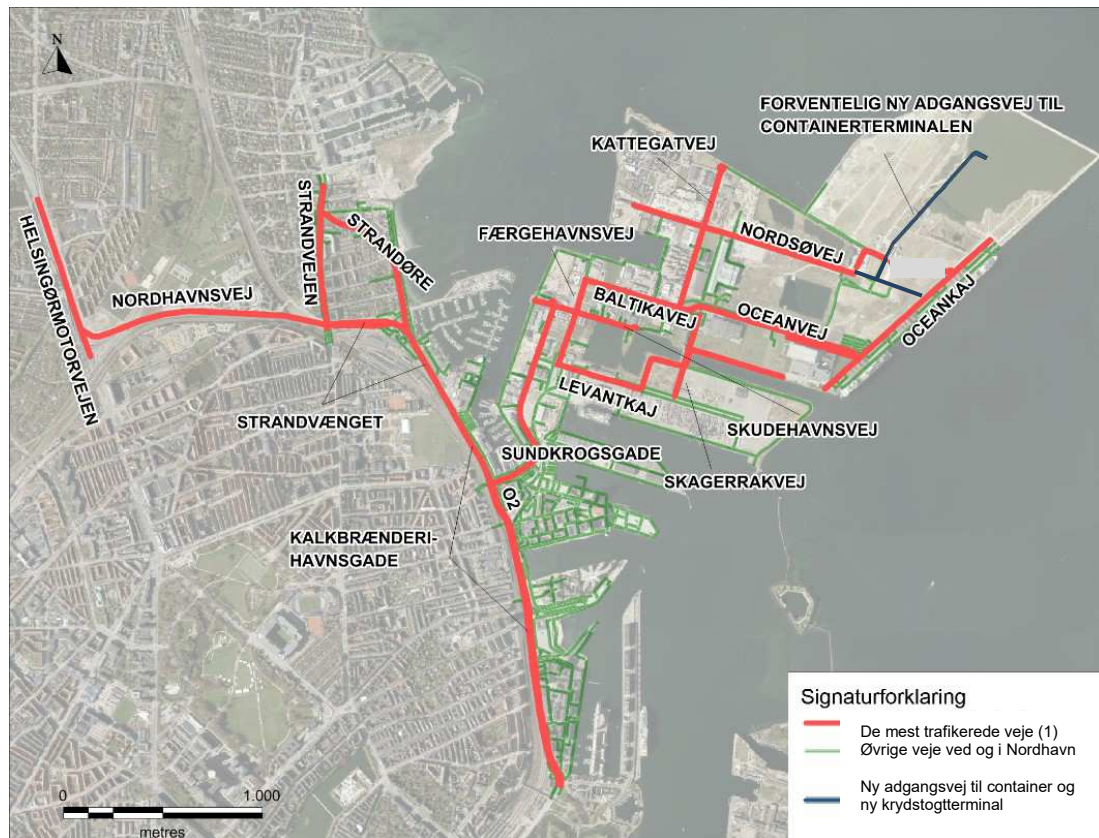
Figur 4-4 De veje (1), som er eller vil blive berørt af trafik i tilknytning til de nuværende terminaler og de nye terminaler, er vist med rødt. De øvrige lokale veje (grøn) ventes ikke påvirket væsentligt. Omtrentlig placering af de nye adgangsveje er skitseret (blå).
