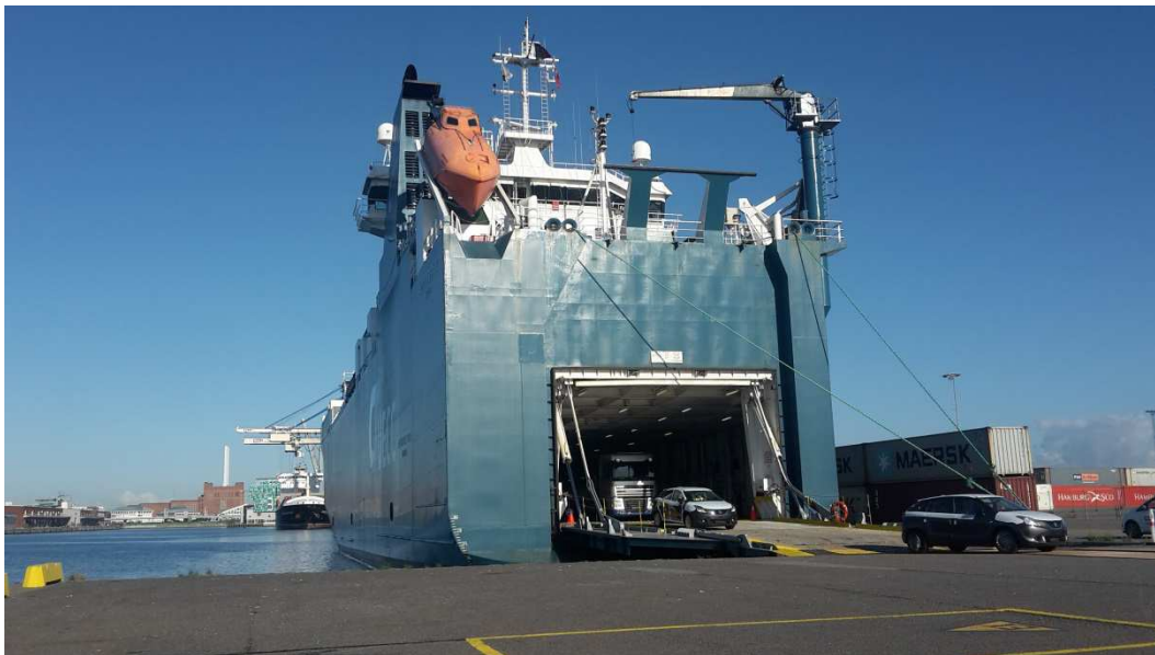
Figur 2 - Eksempel på ro-ro rampe, hvor stykgods kan køres direkte på land fra skibet.
