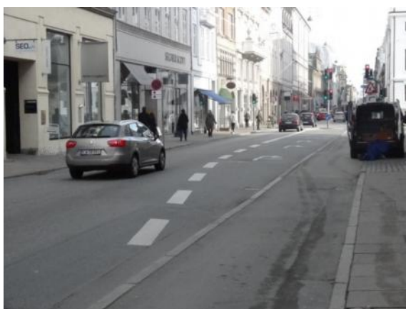
Figur 11. Fremkørsel mod krydset Bredgade/Sankt Annæ Plads, hvor der er etableret bundet højresving og kun et gennemgående spor.
