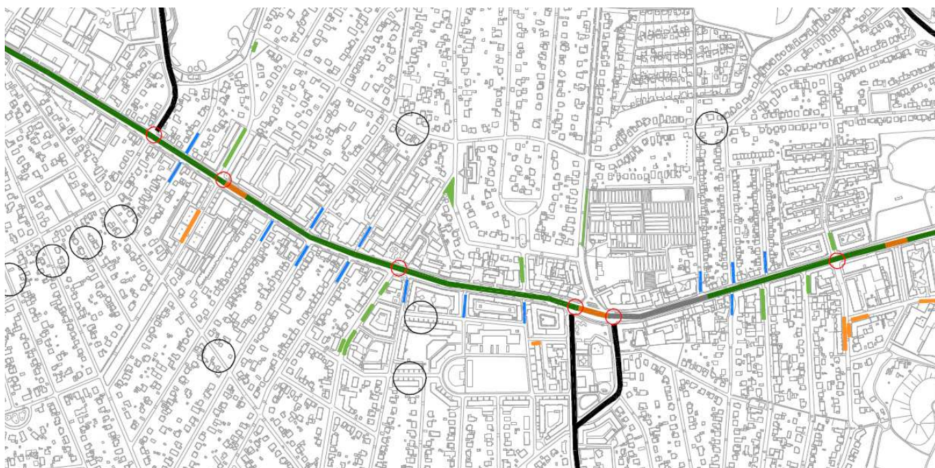
Figur 7: Fysiske tiltag for at sikre en 1:1 relokalisering af parkeringspladser i lokalområdet og modvirke utilsigtede konsekvenser af ændret trafikafvikling. Signaturforklaring:
