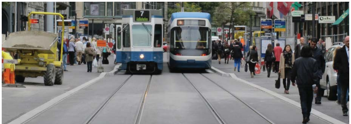
Eksempel på anvendelse af rilleskinner i Zürich, 2013.
