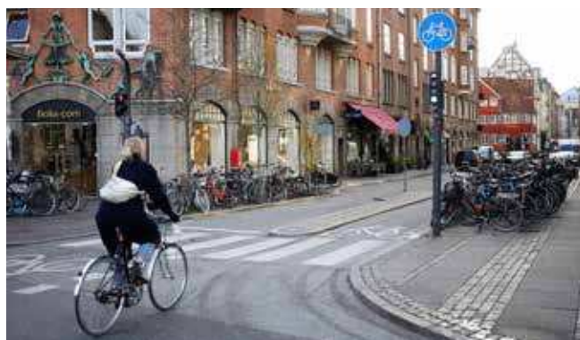
Vejlukning med cykelsluse på Møntergade
