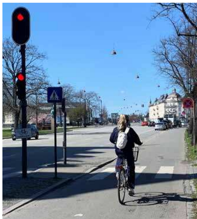
Tilladt ligeudkørsel for rødt i T-kryds, Grønningen
