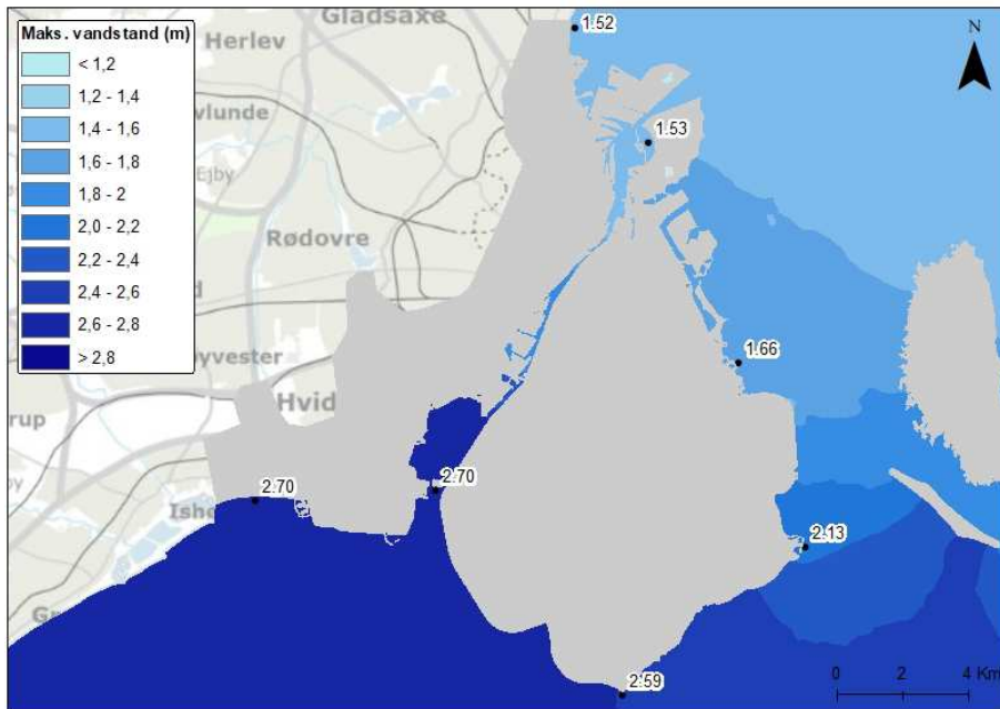
Figur 7.15. Vandstandsgradienten langs hovedstadskysten ved modelberegninger af 1872-stormfloden. Tallene angiver maksimalvandstand i referencepunkterne.
