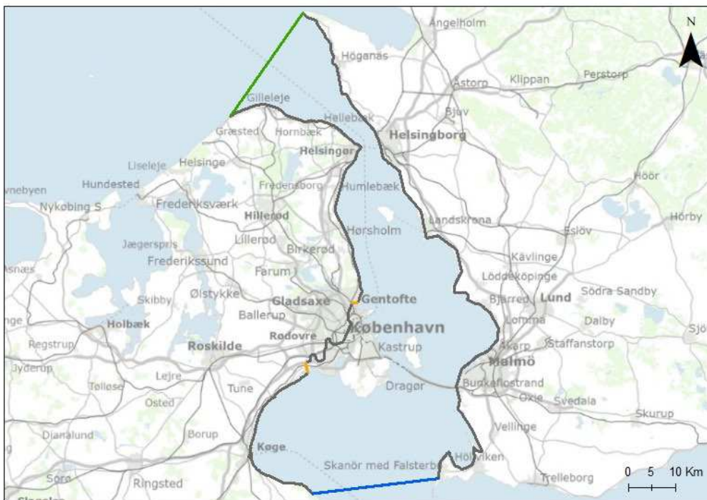
Figur 7.2. Modeldomæne til oversvømmelsesberegninger for ekstremhændelser fra syd.
