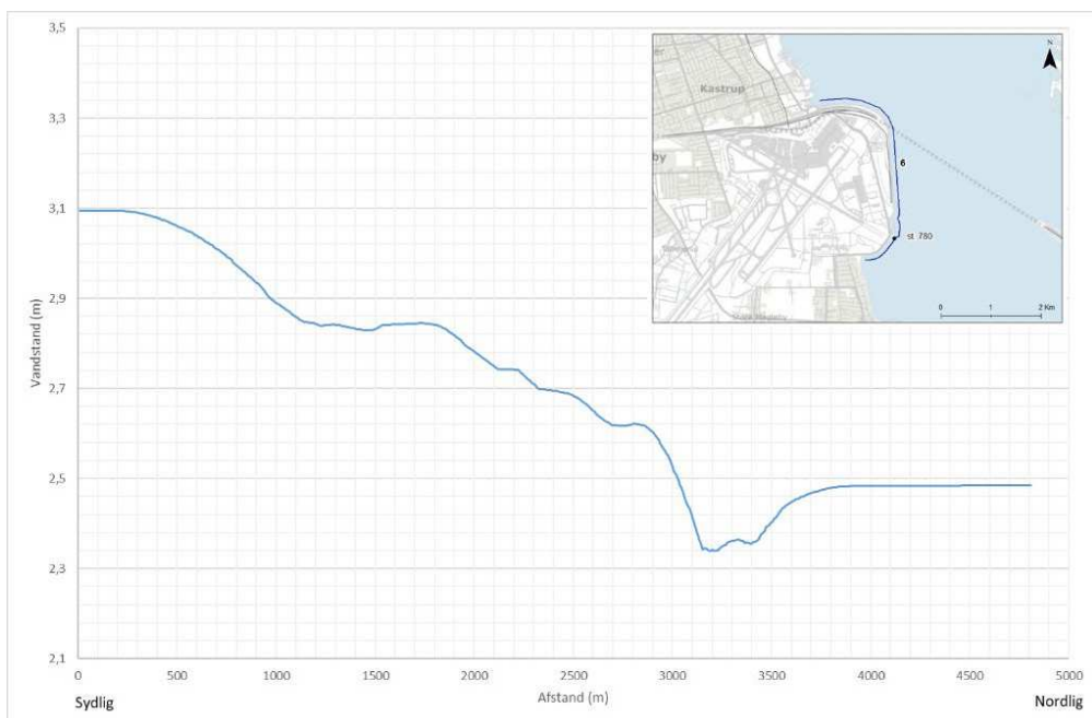
Figur 8.6. Modelleret forløb af den maksimale vandstand for hver 10 m langs delstrækning 6 for designvandstand 3,80 m DVR90.
