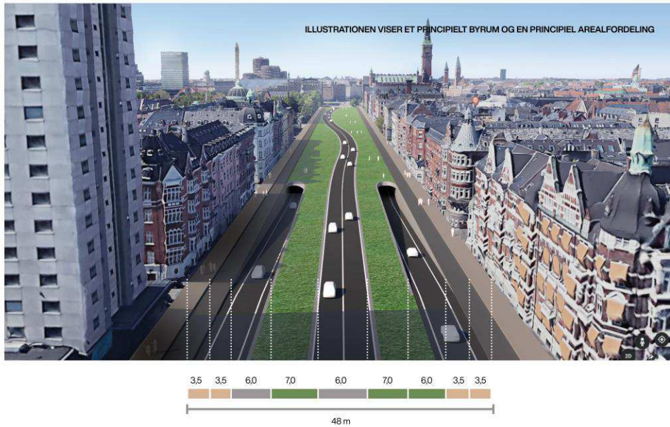
Eksempel på til- og frakørselsramper i byrummet
