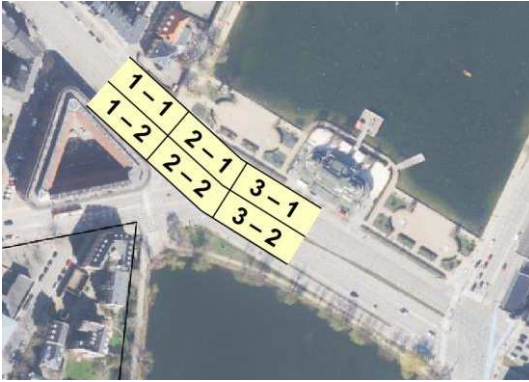
Figur 4-12 Eksempel på opdeling af strækning i delarbejdspladser,
