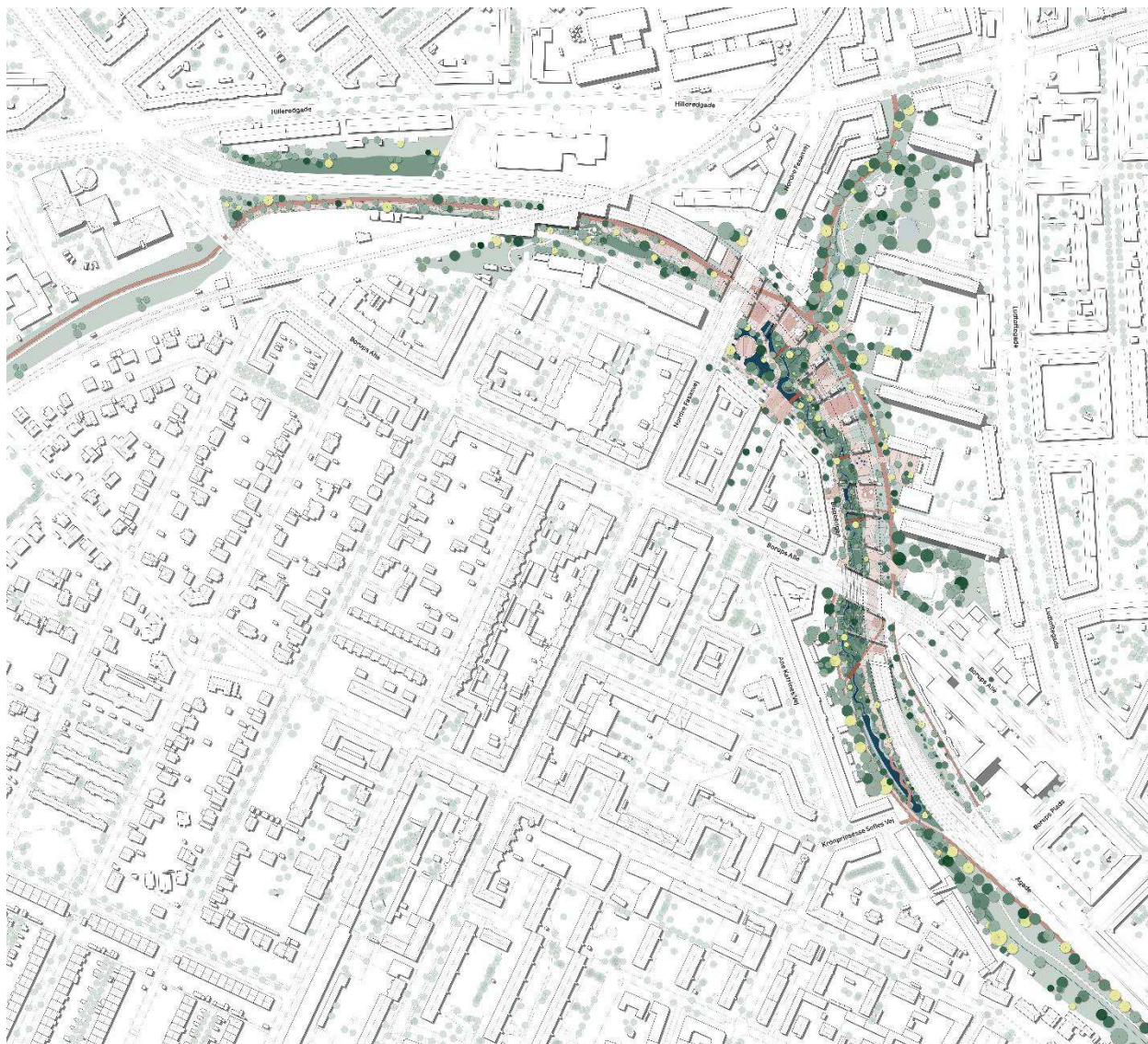
Figur 3-4 Den sydlige Bispeengbuebro nedrives og der kan etableres byrum. Trafikken afvikles på den nordlige Bispeengbuebro (vist stipleet) og gennem de to nordlige rør under ringbanen. 6 (ill. Team Vandkunsten)
