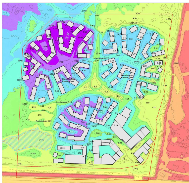
Tærænkort, som viser detaljerede tærænkoter i det fremtidige område. Illustration: Bygherre/MOE.
