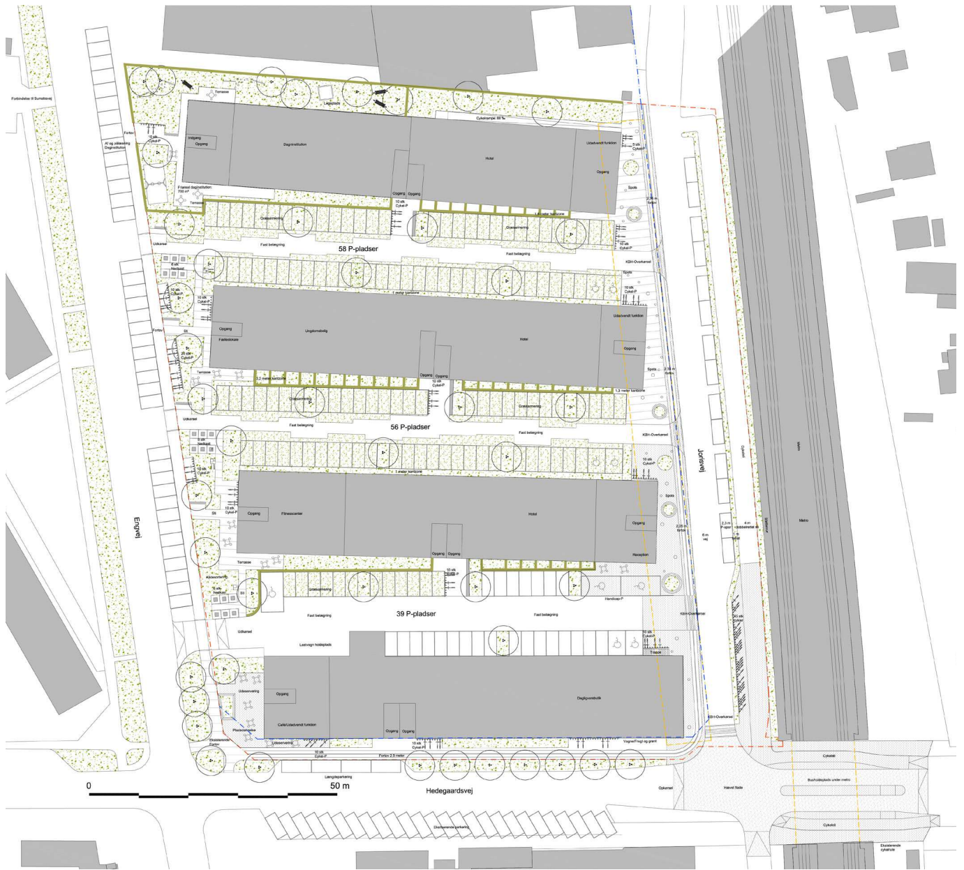
Bygherres udkast til situationsplan, der viser byggefelter, friarealer på terræn samt parkerings- og færdselsarealer. Ill. Opland.
