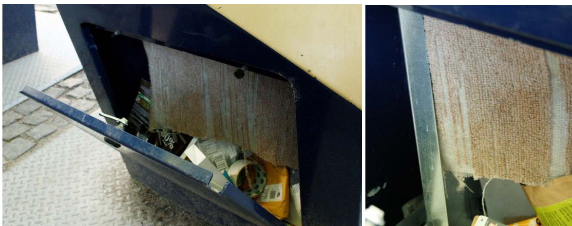
Figur 4.8 viser den indsatte ledetragt med gulvtæpperester til forhindring af materialeprop.
