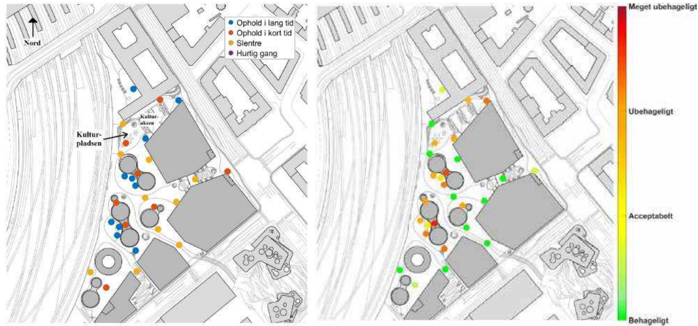
Figur 0.1. Illustration af vindmiljøet i fokusområderne for Postgrundens forventede aktiviteter uden lokal lægning. Venstre: Forventet aktivitetsniveau ved målepunkter. Højre: Vindmiljøet målt i vindtunnelen.
