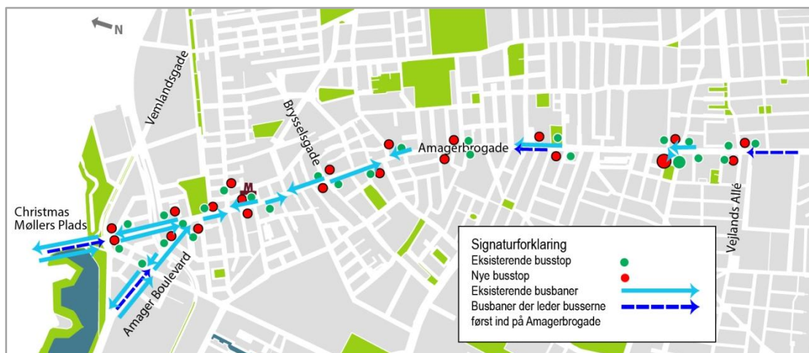
Figur 6: Busbaner og stoppesteder på Amagerbrogade i dagens situation (grønne prikker og lyseblå pile) og i den ændrede helhedsplan (røde prikker og mørkeblå pile).
