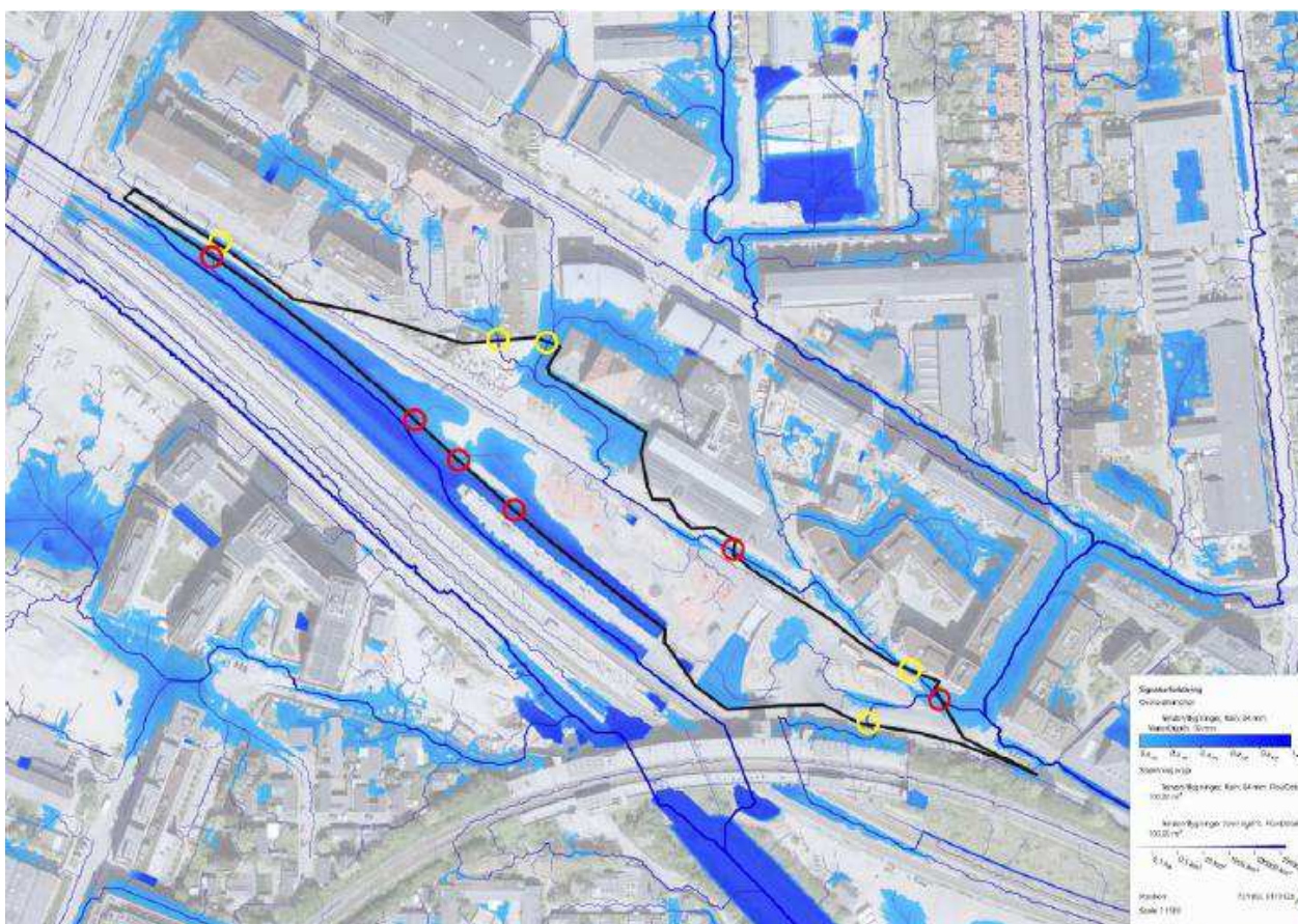
Figur 19.1: Scalgoanalyse af ekstremregn. De gule cirkler angiver eksisterende strømningsveje ind i projektområdet, mens de røde cirkler angiver eksisterende strømningsveje ud af projektområdet /Bilag 9/.
