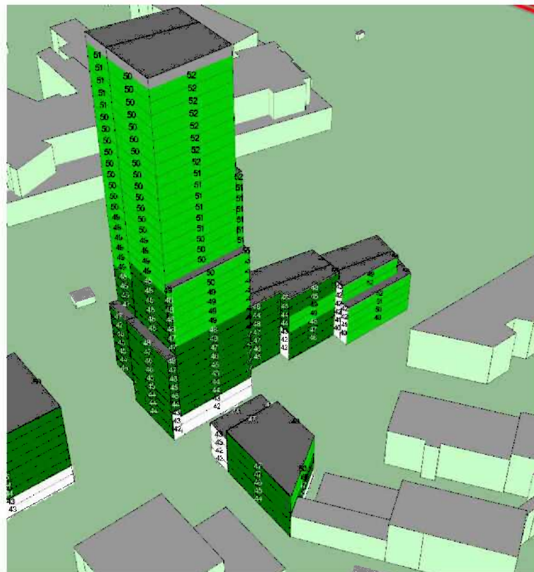
Figur 16: Beregnet vejstøjbelastning L_{den} i dB, Byggefelt 3 og 4, set fra øst.
