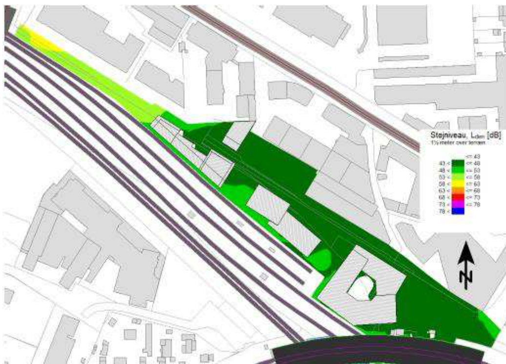
Figur 9.29: Beregnet trafikstøjbelastning på planområdets udearealer i terræn /bilag 2/.
