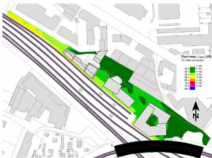
Figur 10: Beregnet jernbanestøjbelastning L_{den} i dB på planområdets udearealer.
