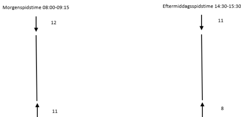
Figur 2 Den gennemsnitlige ind- og udekørende trafik i et hverdagsdøgn for henholdsvis morgen- og eftermiddagsspidsstimen.
