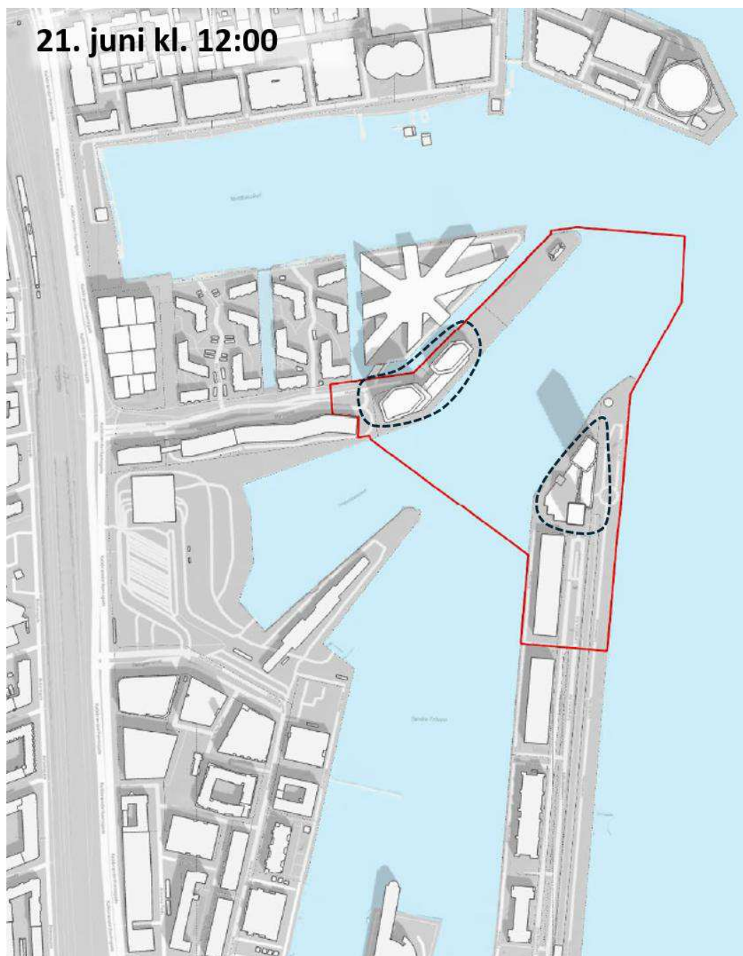
Figur 13-14. Simulering af skyggepåvirkning fra projektet. Projektets bygninger er markeret med stiplede sort linje. Lendager, 2026.
