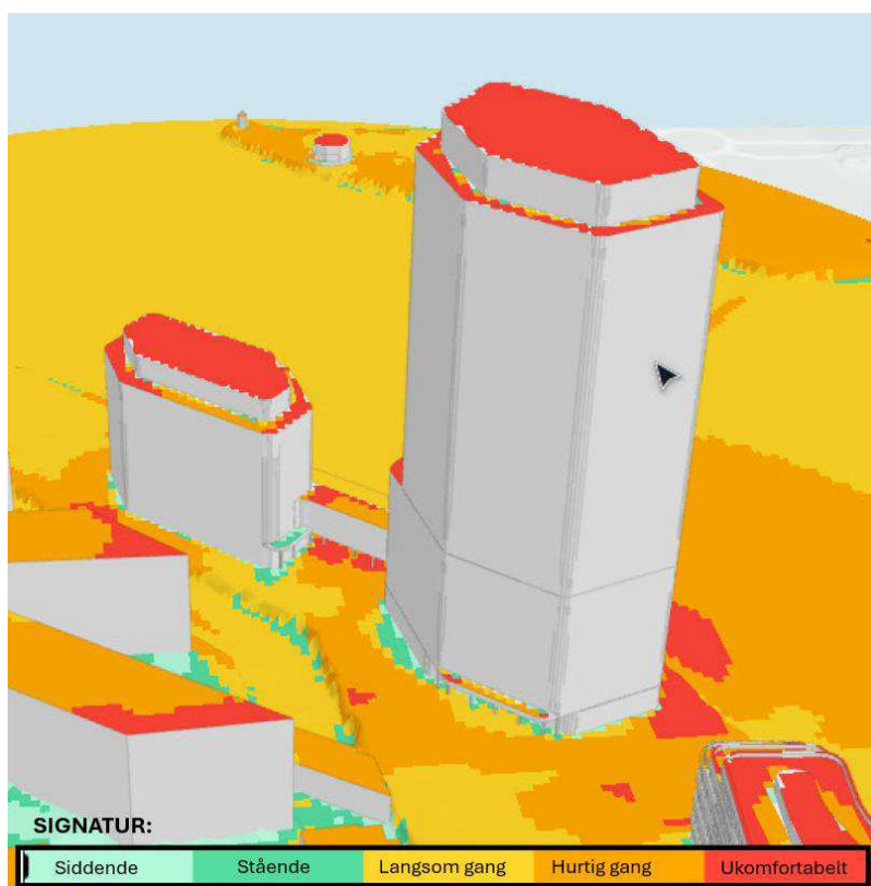
Figur 13-3. Vindkomfortanalyse for området omkring Marmormolen. Set fra vest mod øst. Skalaen viser, hvilken aktivitet, der kan udføres komfortabelt. Rød markering angiver kraftig vind, som er ukomfortable uanset aktivitetsniveau. Svend Ole Hansen ApS, 2025
