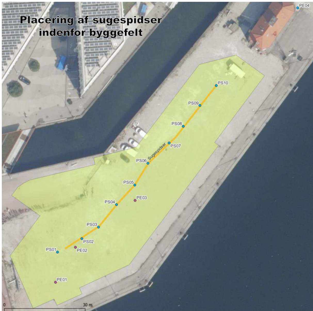
Figur 11-6. Oversigtskort for prøvepumpning. Linje med placering af 40 stk. sugespidsler med ca. 2 m mellemrum er vist med orange streg. 10 stk. af sugespidslerne er taget ud og anvendt som pejlespidser. Disse er navngivet PS01 – PS10. Pejleboringerne PE01-PE04 er tidligere udførte boringer, der er genanvendt til pejling under forsøget (DMR, 2025).
