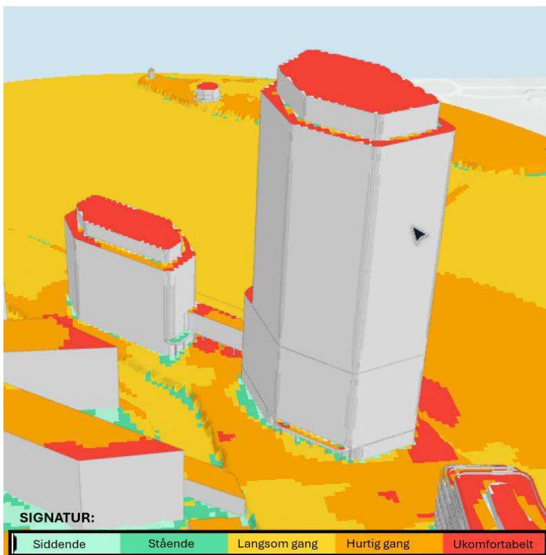
Figur 9-4. Vindkomfortanalyse for området omkring Marmormolen. Set fra vest mod øst. Skalaen viser, hvilken aktivitet, der kan udføres komfortabelt. Rød markering angiver kraftig vind, som er ukomfortable uanset aktivitetsniveau. Svend Ole Hansen ApS, 2025
