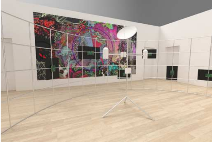
Teknisk skitse af metal-konstruktion. Sensorinstrumentets struktur (en simulerende arktisk vejrstation) er fremstillet af aluminiumsprofiler i målene 30x30 mm. Rendering: Gudrun Havsteen-Mikkelsen.
