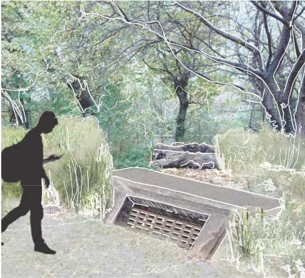
(tv) Zoom 3A Visualisering af skybrudsbygværk ved baneunderføring i Grøndalsengen.
