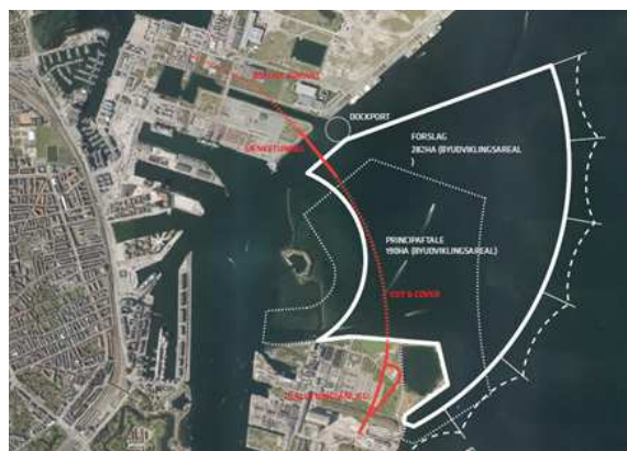
Figur 3: Principskitse af Østlig Ringvej (B1-linjeføring) i forhold til Lynetteholm, og hvor den tilsluttes.
