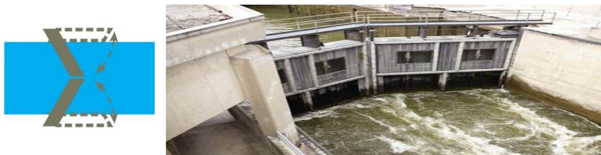
Figur 41: Vertikalt hængslede porte, principskitse (venstre) samt eksempel af implementeret portdesign (højre) (Google image, 2019b)
