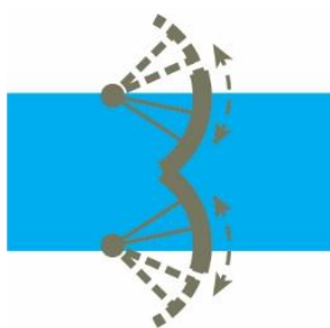
Figur 43: Vertikalt roterende porte, principskitse (venstre) og eksempel af implementeret portdesign fra Maeslantportene, Rotterdam (Google image, 2019d)
