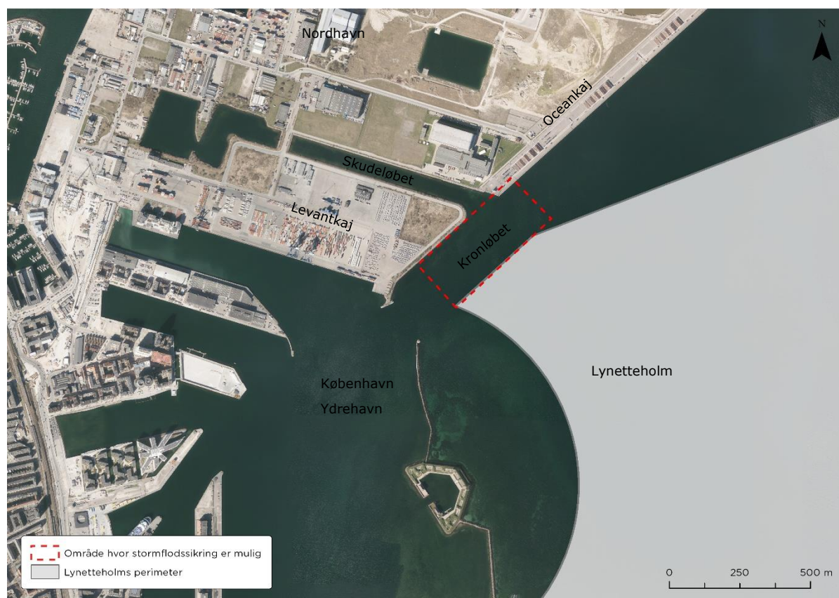
Figur 28: Område markeret med rød, stiplede linje hvori stormflodssikring af Kronløbet er mulig under forudsætning af anlæg af Lynetteholm med august 2019 perimeter
