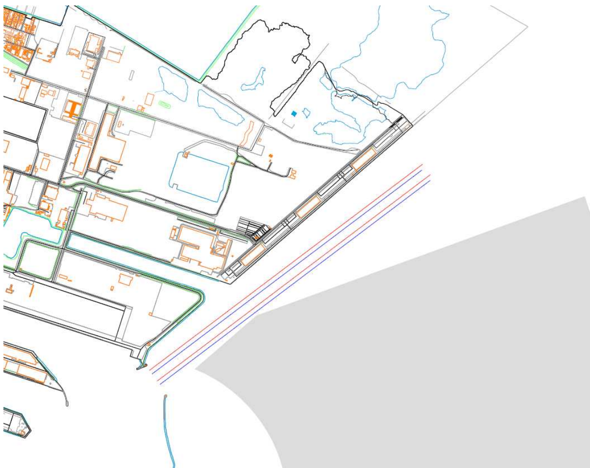
Figur 32: Forslag til sejløb for nye portløsninger. De røde linjer angiver sejløbet for en vippeport, mens de blå linjer angiver sejløbet for en skydeport.
