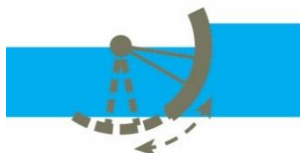
Figur 44: Horisontalt roterende sektioner, principskitse (venstre) og eksempel af implementeret portdesign fra Ems barrieren, Tyskland (højre) (Google image, 2019e)
