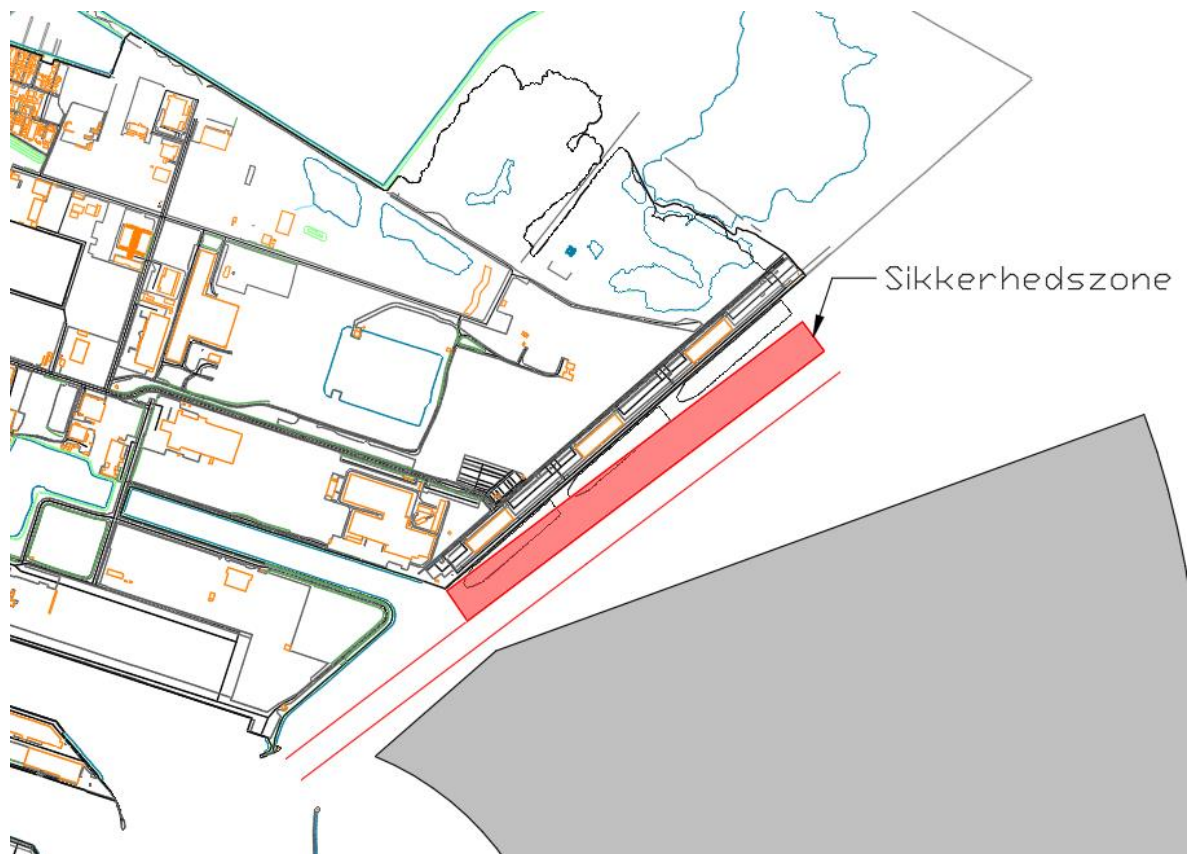
Figur 33: Placering af sejlløb for vippeport samt minimumssikkerhedszone mod fortøjede skibe
