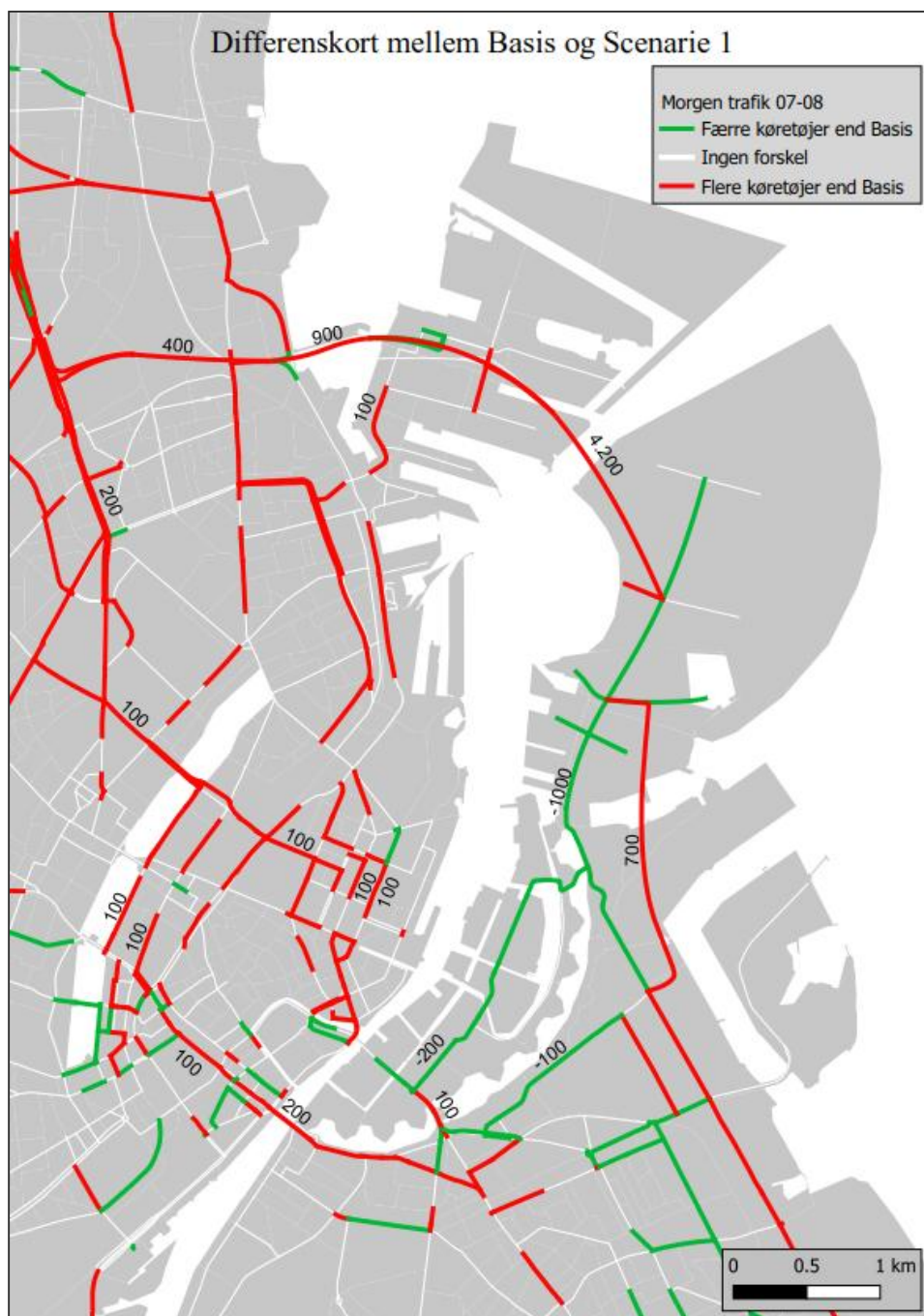
Figur 53 Forskel i trafikal belastning mellem scenarie 1 og basisscenaariet, baseret på OTM. Morgenspidstime.
