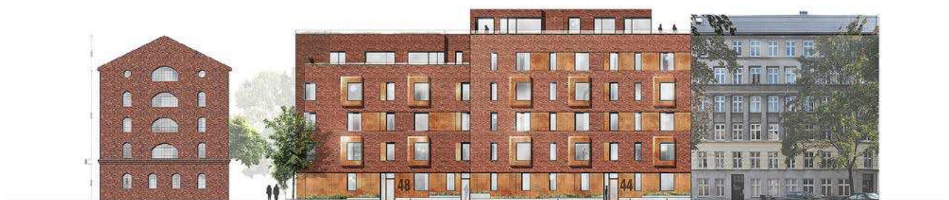
Facadeillustration af forhuset mod Viborggade. Forhuset udføres i 5 og 6 etager. Gesimshøjder er tilpasset nabobygninger. (Arkitema)
