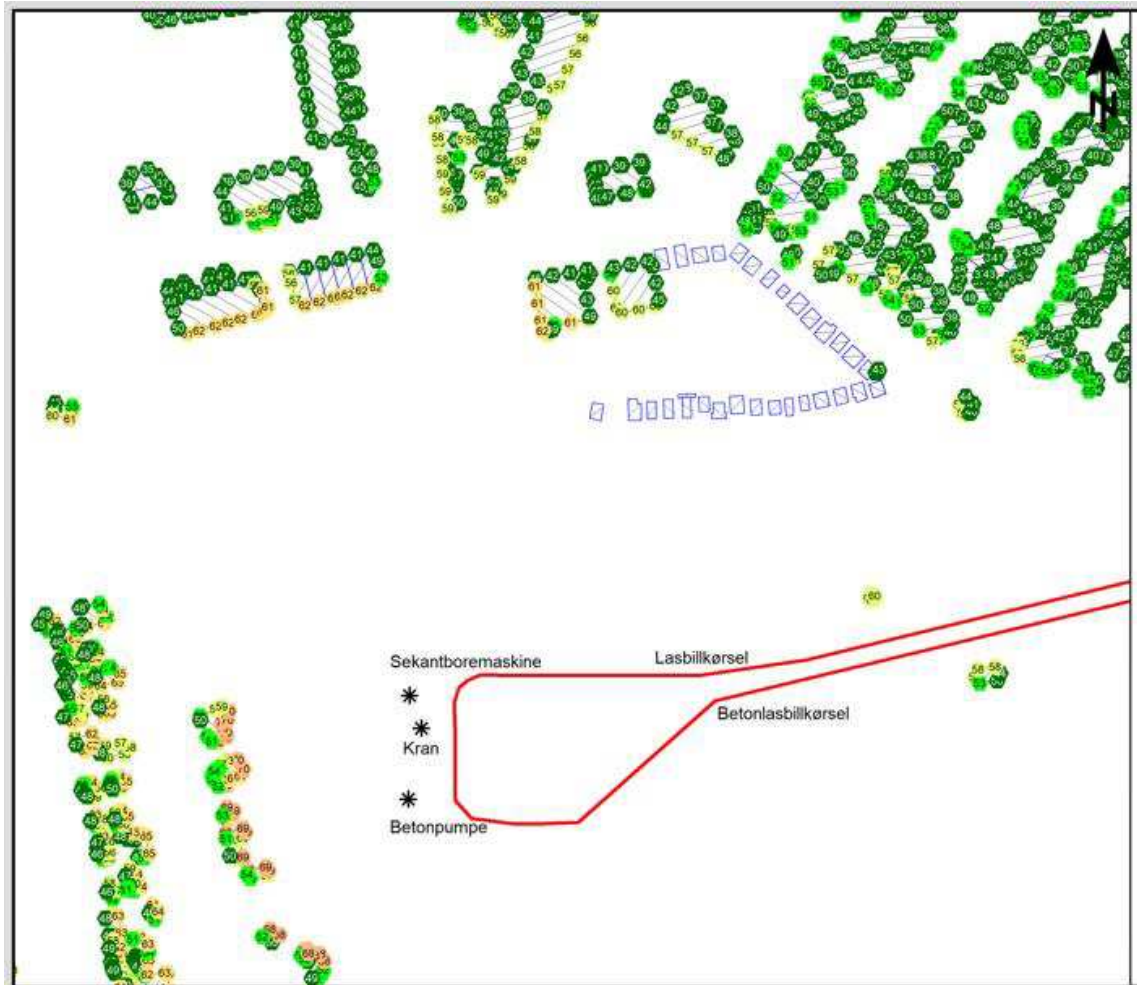
Figur 9.23: Støj fra anlægsarbejder i byggefase 1 for byggepladsen ved Enghave Kanal, hvor der etableres sekantpæle til skakten. Støjkortet medtager ikke tillæg for hørbare impulser på 5 dB.
