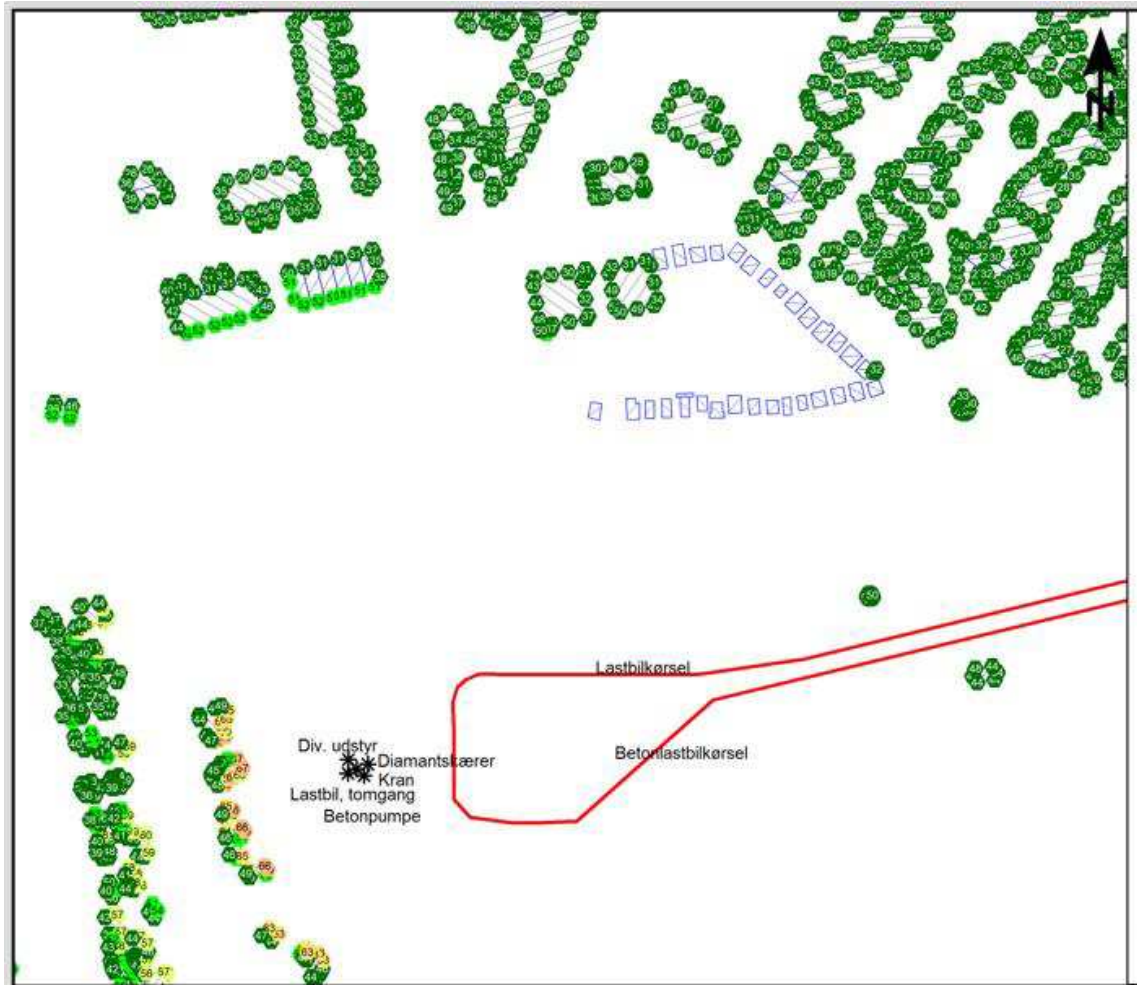
Figur 9.26: Støj fra anlægsarbejder i byggefase 10 for byggepladsen ved Enghave Kanal, støbning af udløbsbygværk. Støjkortet medtager ikke tillæg for hørbare impulser på 5 dB.
