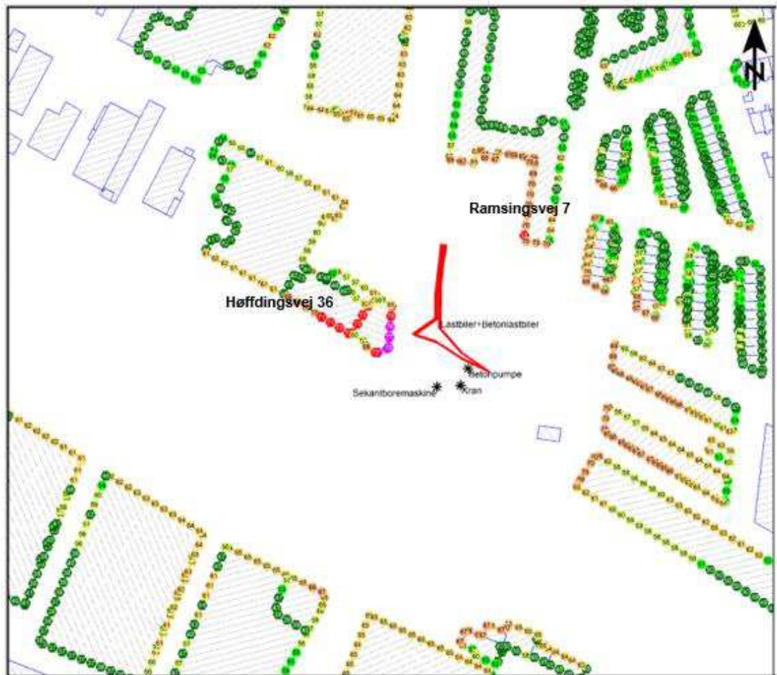
Figur 9.4: Støj fra anlægsarbejder i byggefase 1 for byggepladsen ved FLSmidth, hvor der etableres sekantpæle til skakten. Støjkortet medtager ikke tillæg for hørbare impulser på 5 dB.
