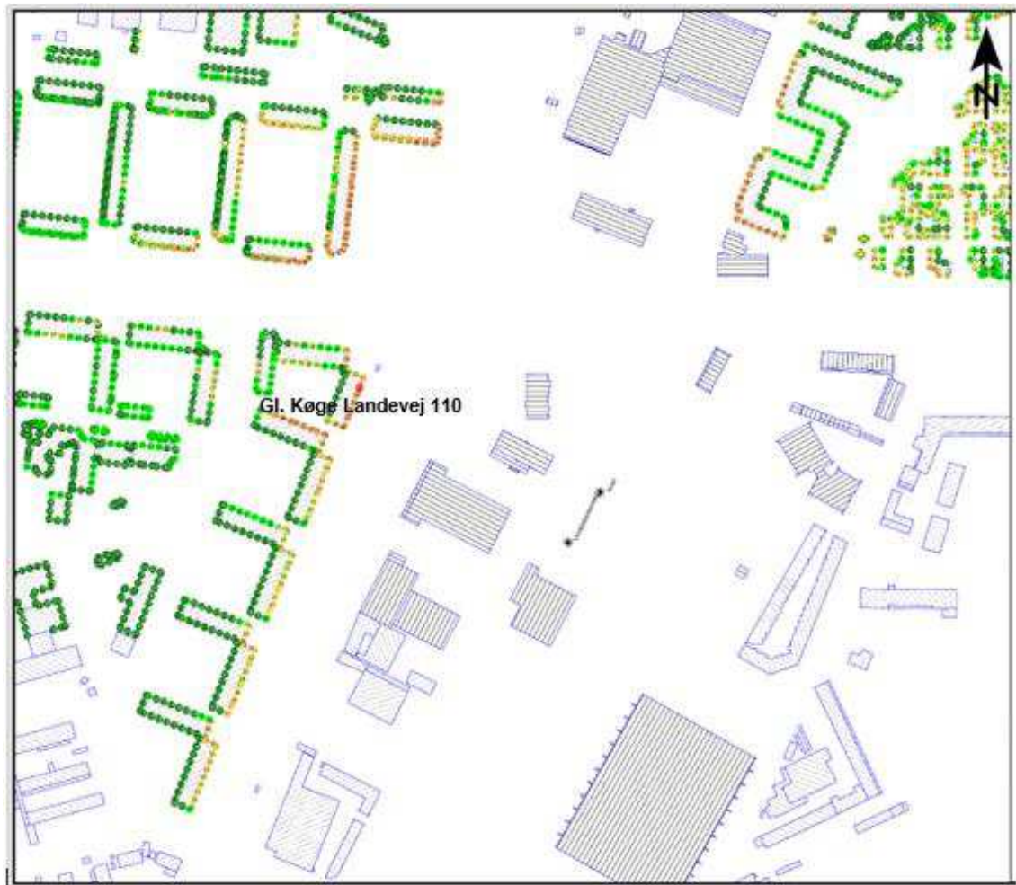
Figur 9.13: Støj på boligfacader fra anlægsarbejder i byggefase 7a for byggepladsen ved Blushøjvej, ved drift af tunnelarbejdspladsen (EPB) om natten forudsat maksimal støjdæmpning af kran.
