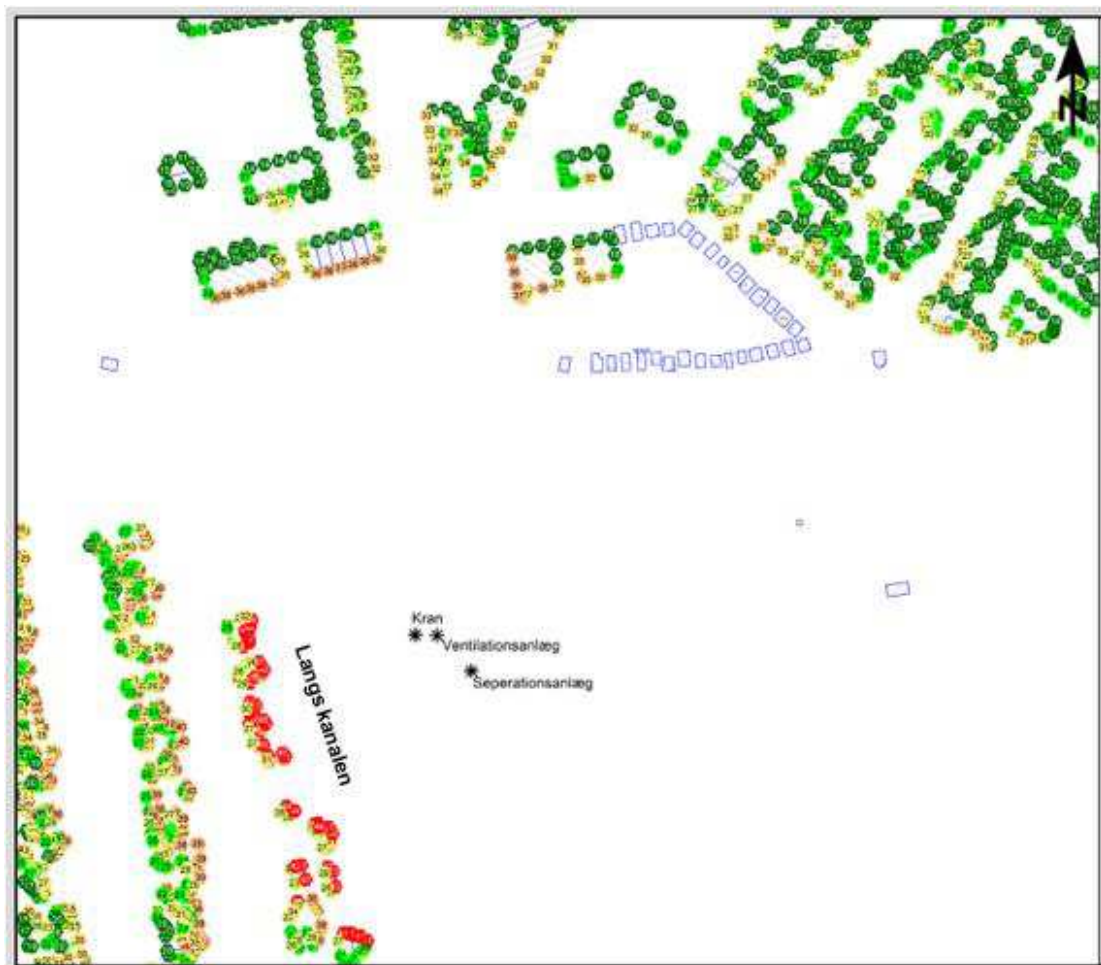
Figur 9.24: Støj fra anlægsarbejder i byggefase 6b for byggepladsen ved Enghave Kanal, ved drift af tunnelarbejdspladsen (slurry-metoden) om natten forudsat maksimal støjdæmpning af kran og separationsanlæg. Tunnelering med EPB viser samme støjubredelse. Haveforeningen Musikbyen er ikke godkendt til overnatning.
