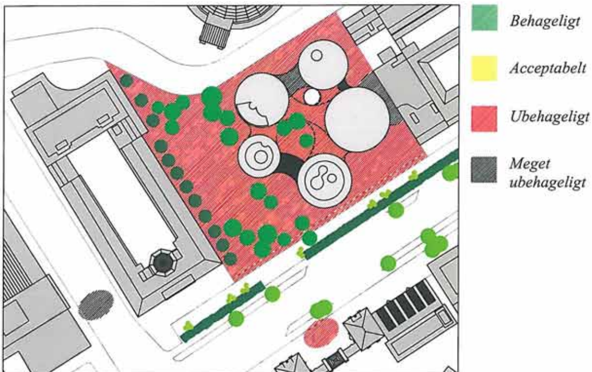
Figur 6.4. Illustration af vindmiljøet ved Axeltorv ved aktiviteten stå eller sidde i længere tid .
