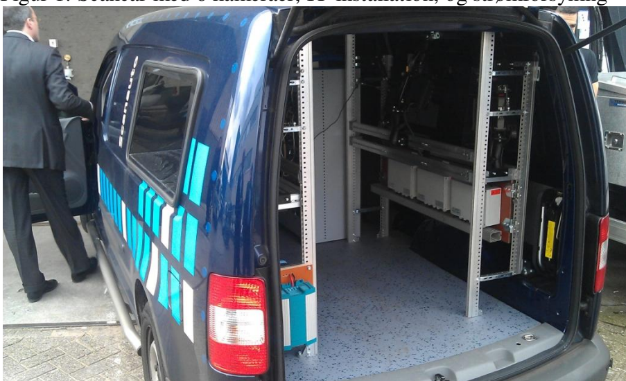
Figur 1: Scancar med 6 kameraer, IT-installation, og strømforsyning
