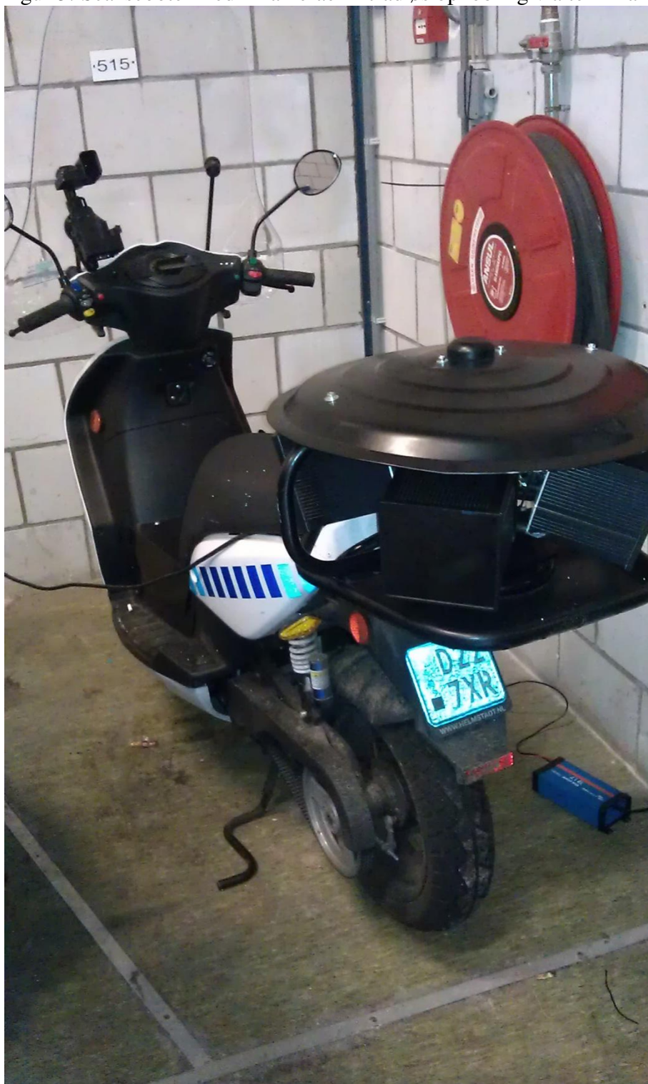
Figur 3: Scanscooter med 2 kameraer + trådløs opkobling via terminal
