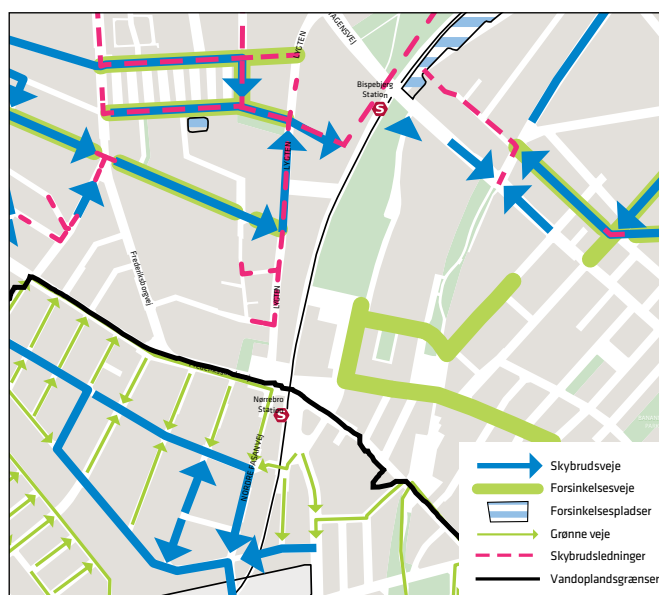
Det hydrauliske oversigtskort, der viser vandets vej.
