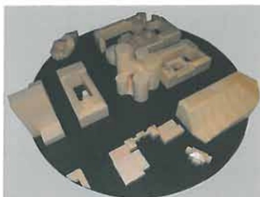
Figur 1.1. Vindtunnelmodel af Axeltorv samt nabobebyggelse.
