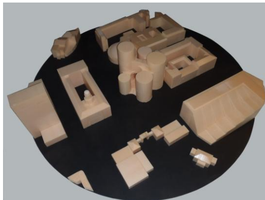
Figur 1.1. Vindtunnelmodel af Axeltorv samt nabobebyggelse.
