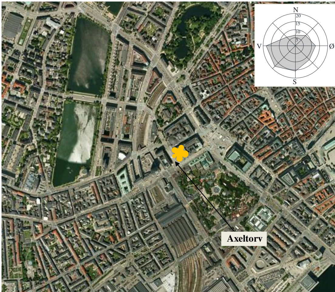
Figur 2.1. Vindrose for vinde i området ved Axeltorv.
