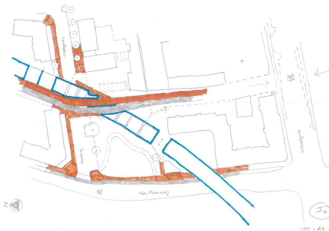
Figur 23 Skitse af underføring i sporvognstracéet, samt mulig smutvej for fodgængere til Tikøbgade over EL-Forbundets arealer, forslag 1B (nord mod venstre). Brun er fortov, grå er cykelsti og blå er konstruktionen af højbanen.
