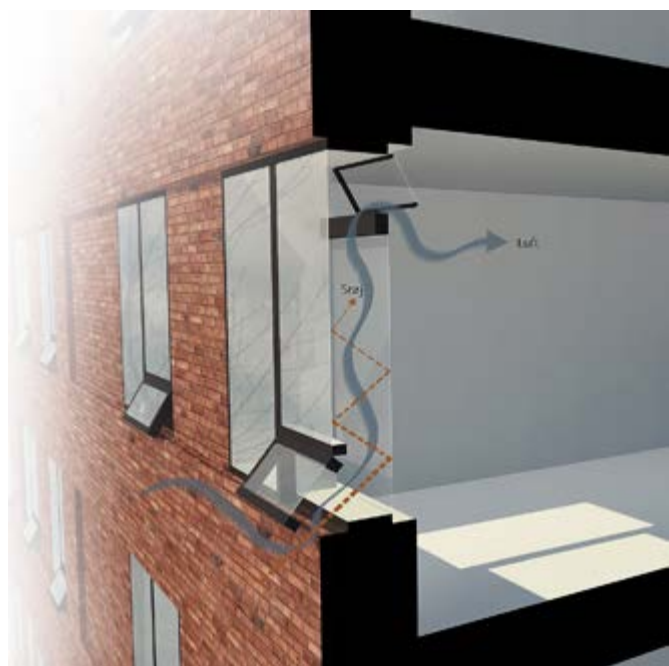
Vinduerne mod støjkilden indrettes, så der kan udluftes, uden at støjen kommer med som vist på visualiseringen. (Illustration Arkitema)
