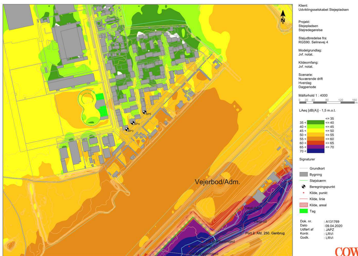
Figur 14-3 Beregning af ekstern støj fra RGS Nordic – hverdage, dagsperioden.
