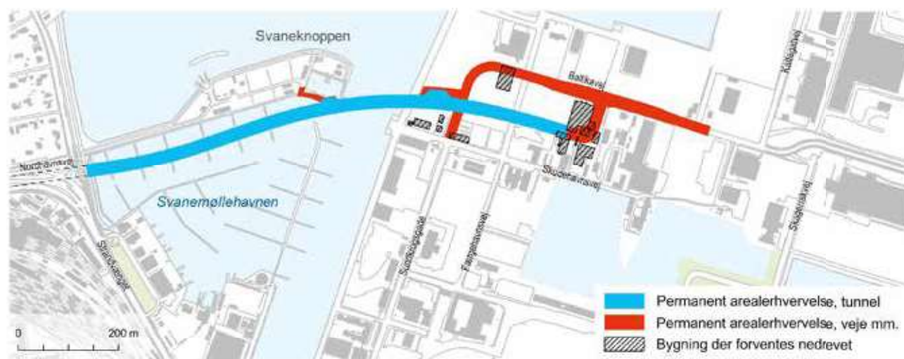
Figur 9.8 Permanent arealinddragelse for løsning D.
