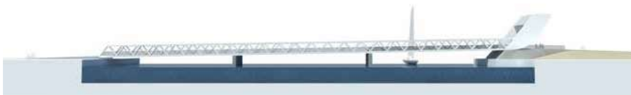
Figur 2.8 Klapproen er ca. 130 meter lang og ca. 5 meter høj.
