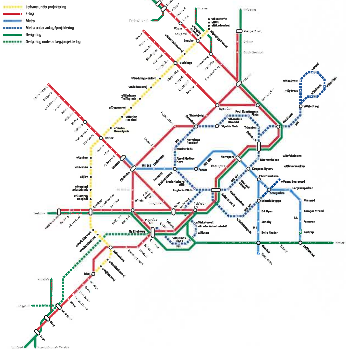
Figur 3.2: Banenet i 2040 - Her vist med stationsplaceringer på Sydhavnsmetroen som i scenarie A, C og E. I 2040 forudsættes M6/M7 etableret mellem København H og v/Prags Boulevard.
